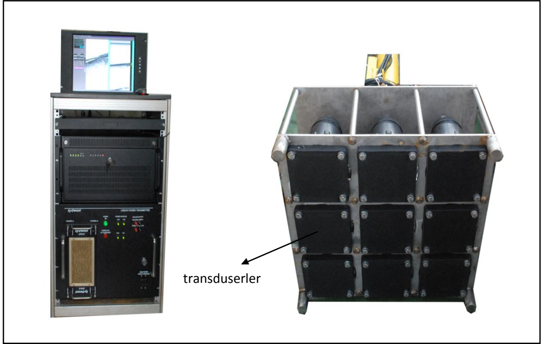
Şekil 2.36 Deniz Bilimleri ve Teknolojisi Enstitüsü'nde kullanılan CHIRP yüksek ayrımlı mühendislik sismği kayııcı ve transduserleri
