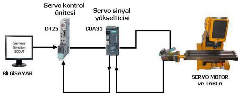
Şekil 2.2 Servo kontrolün sistemimizin bir eksenini gösteren diyagramı
