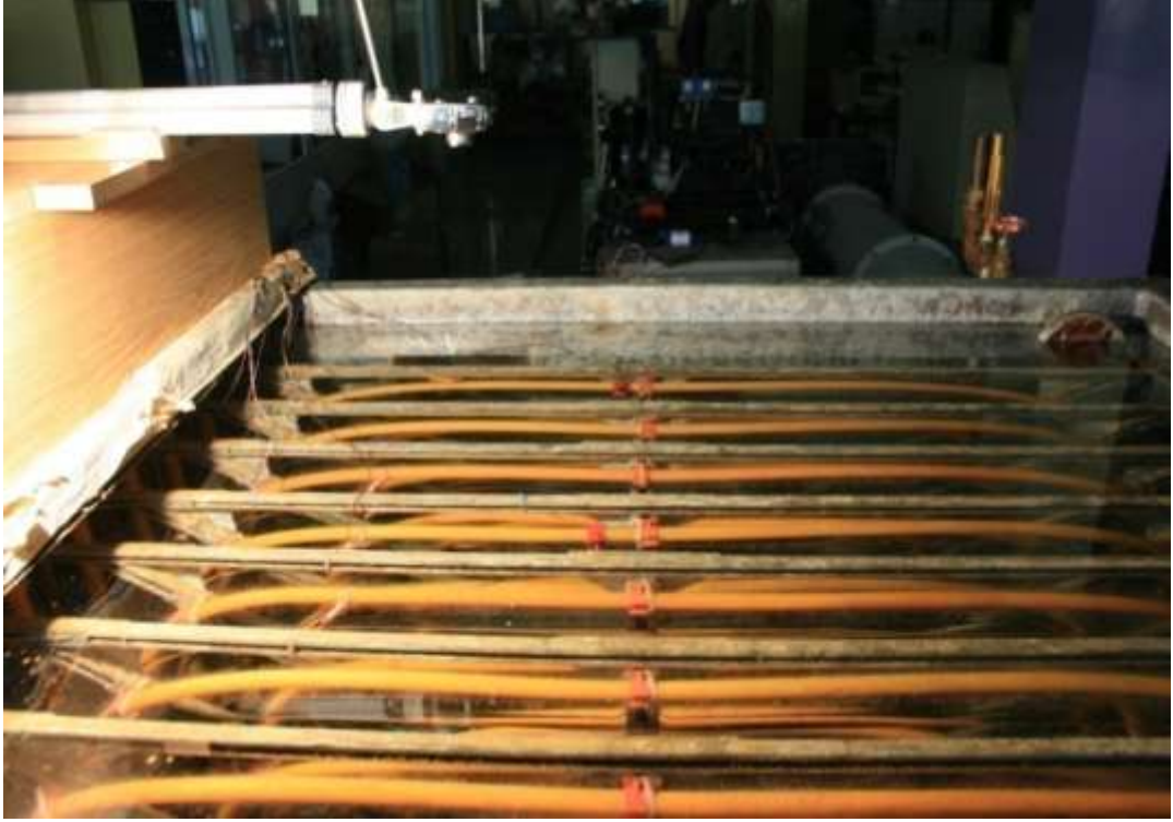
Şekil 3.4 Buz kalınlıklarının deney sırasında fotoğraflanması
