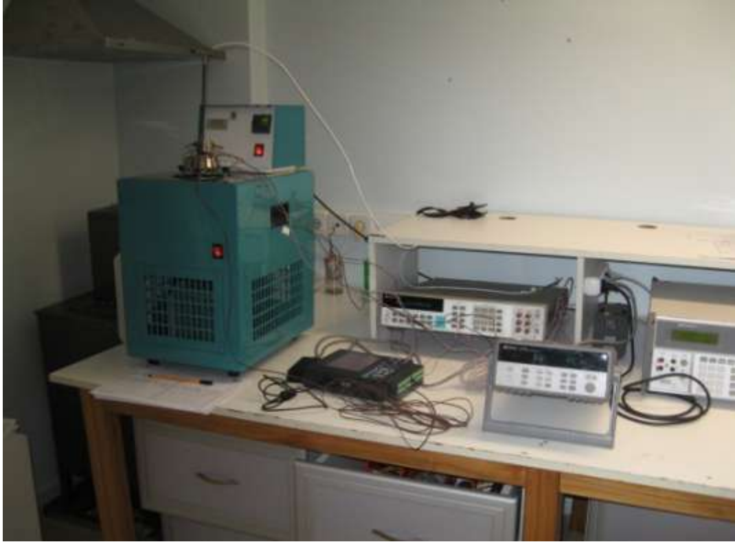
Şekil 3.7 KALMEM kalibrasyon odasında bulunan kalibrasyon banyosu ve HP 34970A Data Logger Cihazına bağlı Isıl Çiftler
