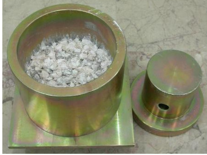
Şekil 5.39 Agrega Kırılma Dayanımı Deney Aletinden Çıkan Numunelerin Görünüşü
