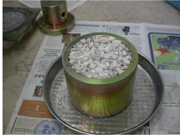
Şekil 5.40 Agrega Kırılma Dayanımı Deney Aletinden Çıkan Numunelerin Görünüşü
