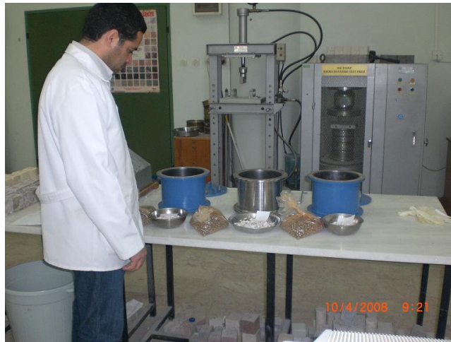
Şekil 5.14 Mikro Deval deney hazırlığı
