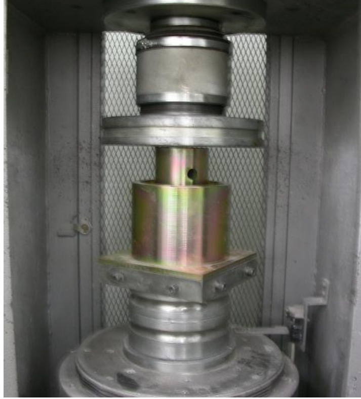
Şekil 5.36 Agreg a Kırılma Dayanımı Deney Aletlerinin TEBD aletine yerleştirilmesi ( TEBD : Tek Eksenli Basınç Dayanımı )
