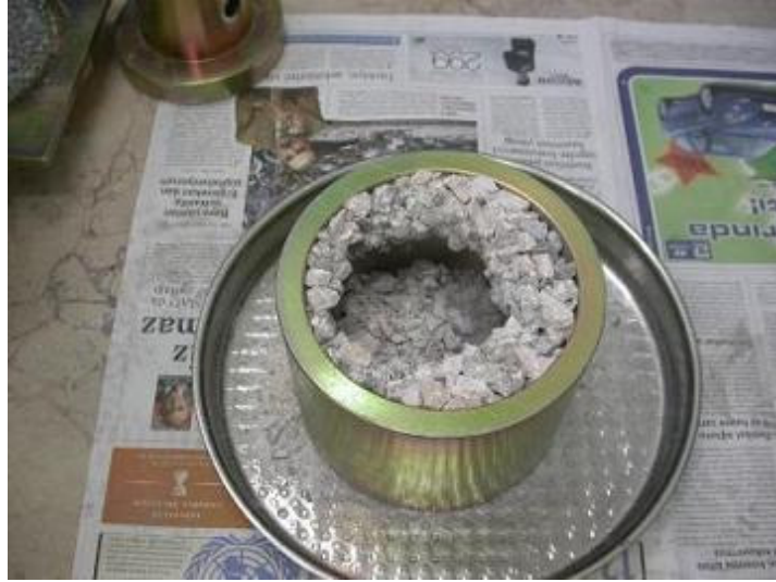
Şekil 5.41 Agrega Kırılma Dayanımı Deney Aletinden Çıkan Numunelerin Görünüşü
