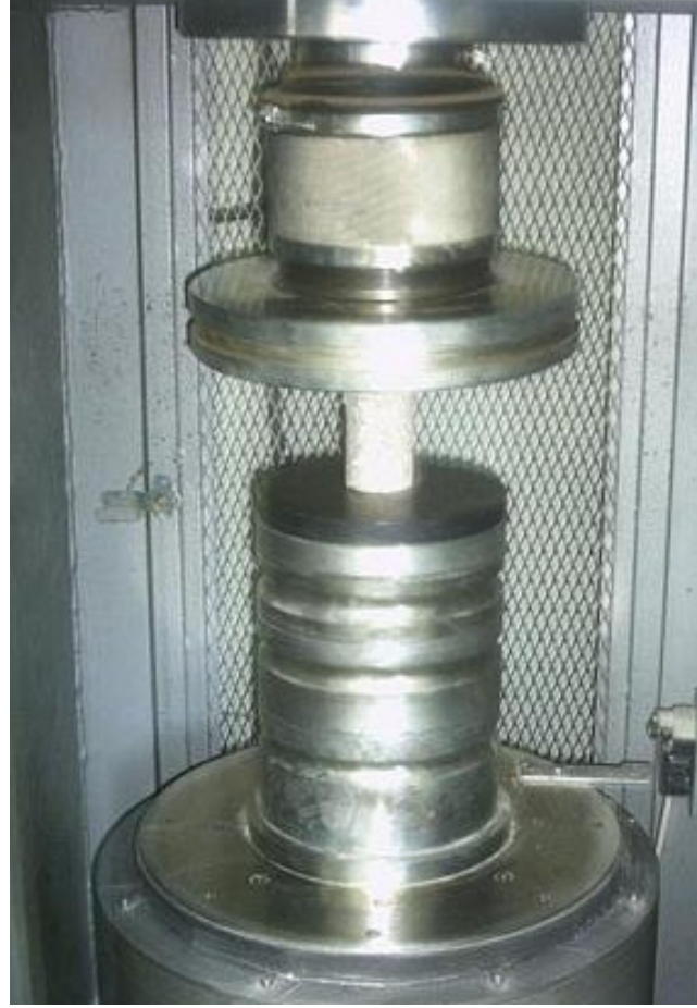
Şekil 5.2 Tek Eksenli Basınç Deney Cihazı ve Deneyin Uygulanışı
