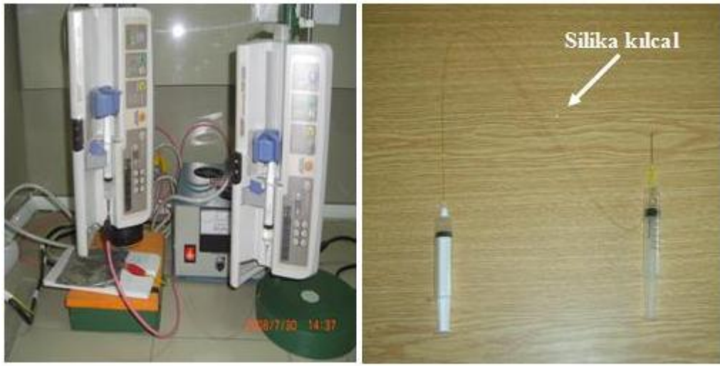
Şekil 6.5 Nanotüp üretimi için kullanılan elektro-eğirme düzeneği ve silika kılcal borular ile birbirine bağlı şırınga sistemi
