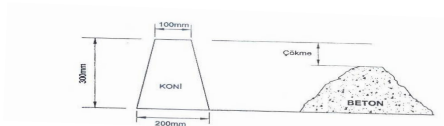
Şekil 3.3 Çökme deneyi (Ersoy ve Özcebe, 2001)
