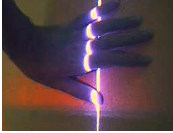
Şekil 3.2 Taranmakta olan bir insan elinin yüzeyinde dikey lazer ışın demetinin oluşturduğu iz.
