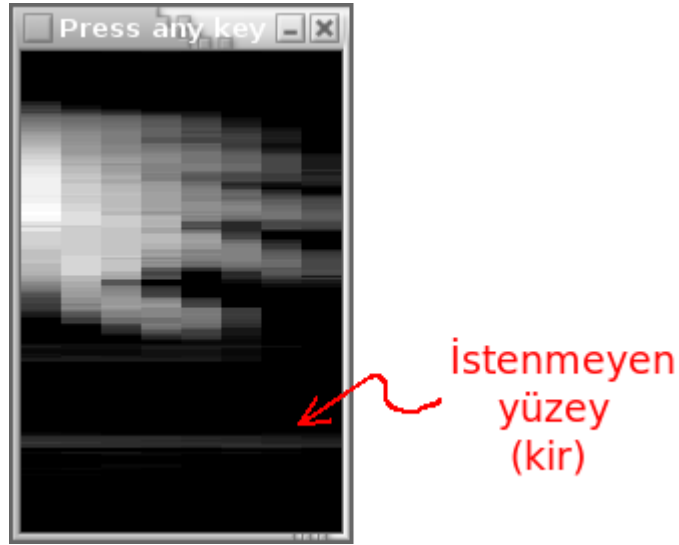
Şekil 4.14 Bir el taraması sonucu. Bu sonuçta, arkaplandaki bir çıkıntı da, istenmeyen bir şekilde sonuca yansımıştır.
