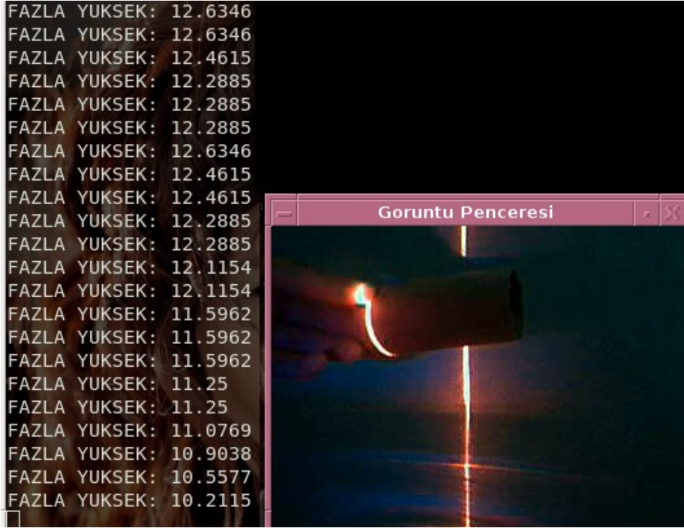
Şekil 4.11 YakarTatar'ın işlevlerinin gerçek zamanlı yükseklik denetimi için kullanımı
