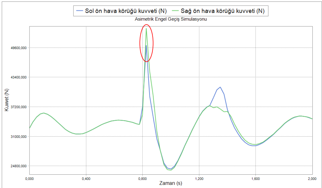
Şekil 6.19 Asimetrik engel geçişinde hava körüğü kuvveti
