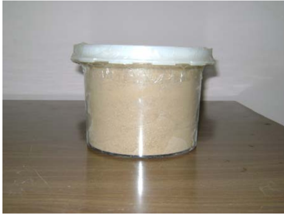
Şekil 3.5 Gama spektroskopik ölçümler için hazırlanan toprak örneği
