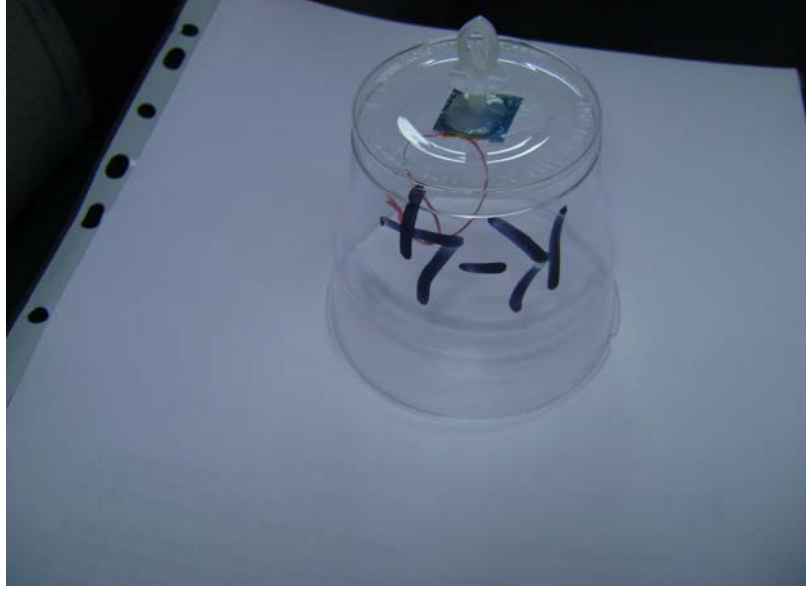
Şekil 3.4 Radon ölçümleri için hazırlanan plastik dedektörler
