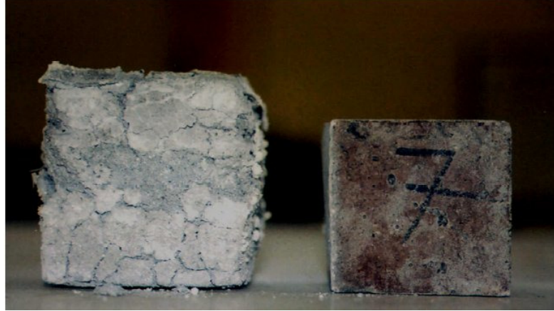
Şekil 3.8 Yüksek oranda alçı taşı (kalsiyum sülfat) içeren harç örneklerinin havada ve su içinde bekletilmeleri halinde 84 gün sonundaki durumları. Soldaki ağır hasarlı örnek su içinde, sağdaki örnek ise havada bekletilmiştir (Baradan ve diğer.,2002).
