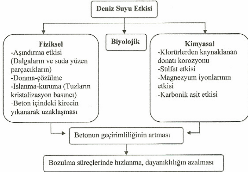
Şekil 3.3. Deniz ortamındaki bulunan yapıların maruz kalabilecekleri yıpratıcı etkiler (Baradan ve diğer, 2002).
