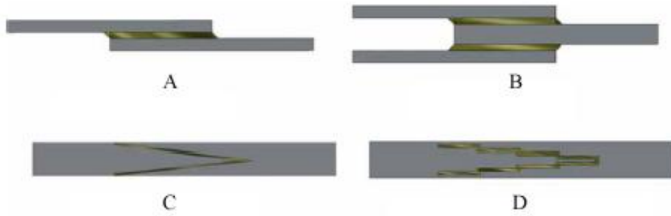
Şekil 4.1 Yapıştırma şekilleri. A. Basit bindirme B. Çift sıralı bindirme C. Birbiri içine geçmeli bindirme D. Basamak şeklinde bindirme
