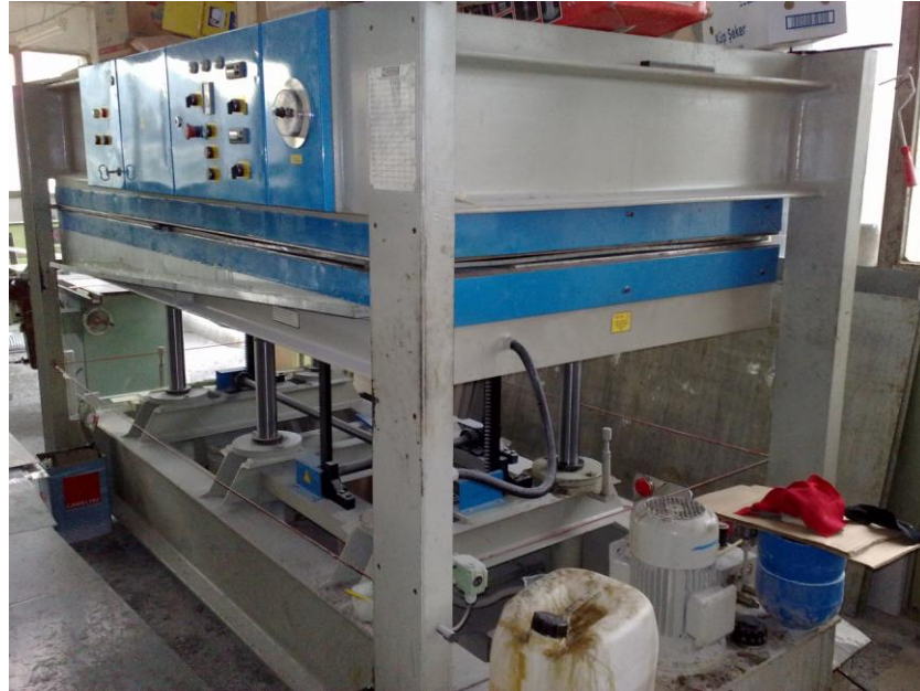
Şekil 5.4 Cam elyaf keçe ve polyester reçine katmanların preslenmesi işlemi
