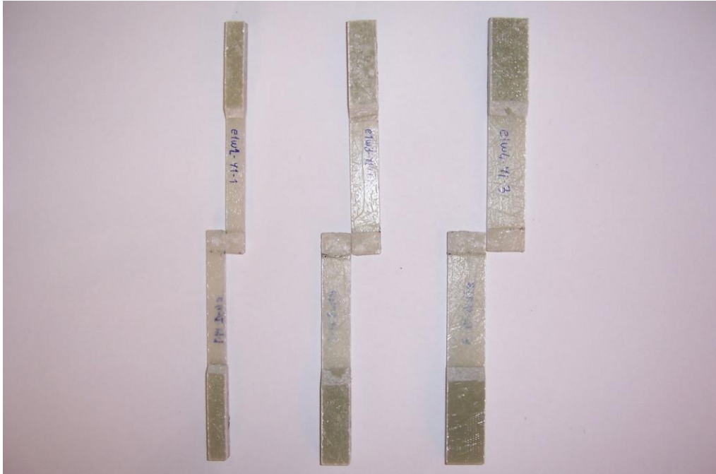
Şekil 6.2 E1W2-Y1, E1W3-Y1, E1W4-Y1 hasar tipleri
