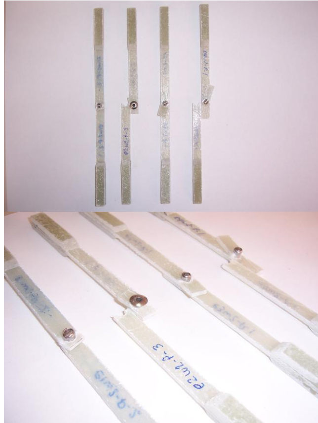
Şekil 6.24 E1W2-P, E2W2-P, E3W2-P, E4W2-P hasar tipleri
