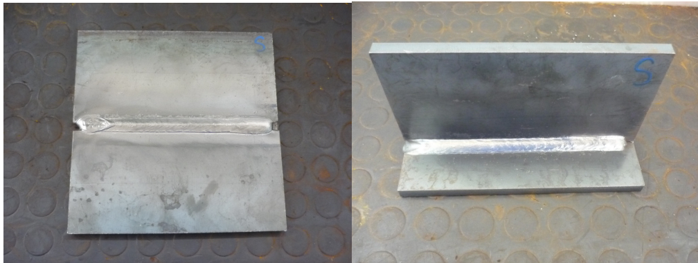
Şekil 5.11 Penetrent testi öncesi temizlenmiş plakalar
