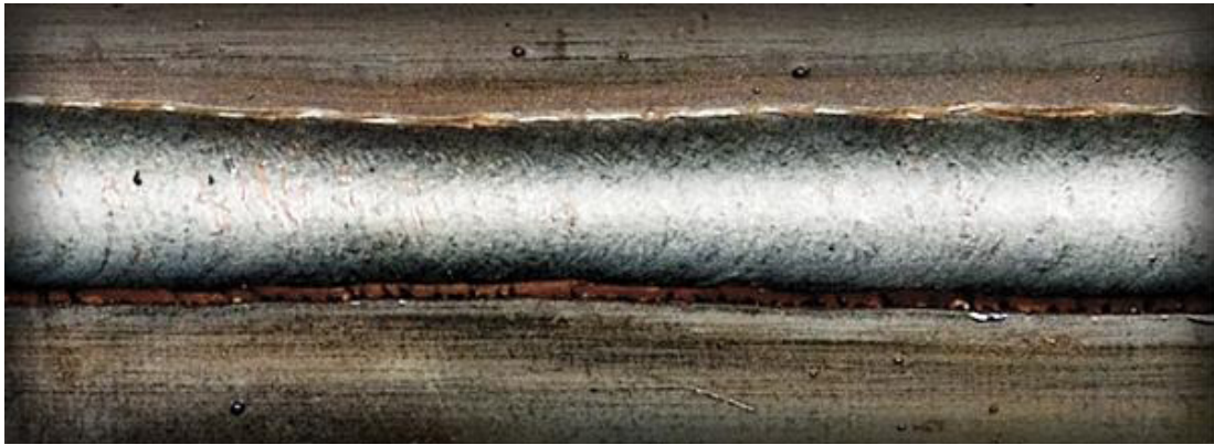
Şekil 3.6 Yavaş kaynakta kaynak dikişinin görünümü
