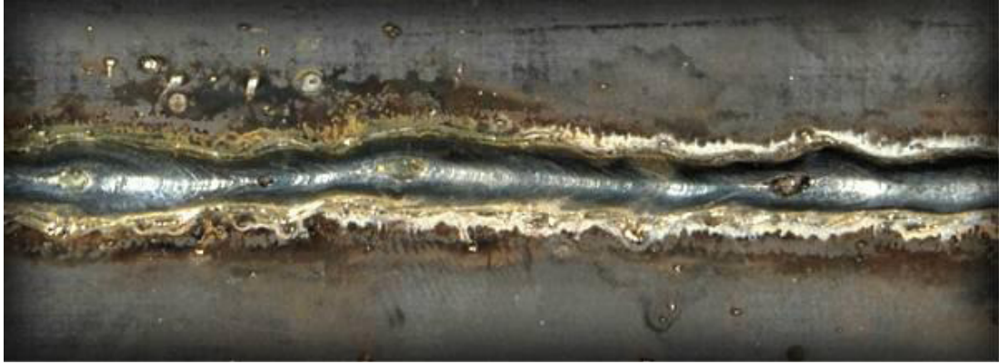
Şekil 3.5 Hızlı kaynakta kaynak dikişinin görünümü
