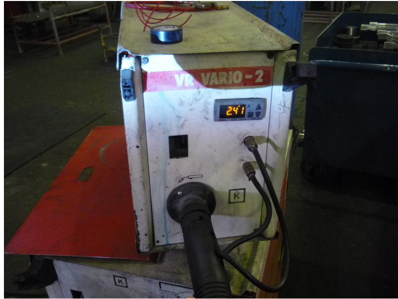
Şekil 5.6 Kaynak makinasına bağlanan ampermetre göstergesi
