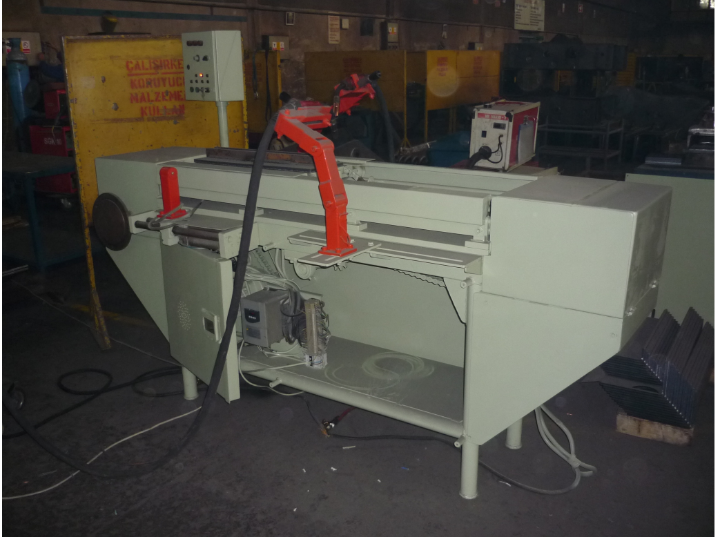
Şekil 5.1. Sacların kaynatılmasında kullanılan otomatik sistemin görünümü
