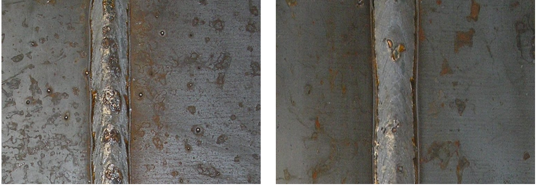
Şekil 6.1 Alışılmış tipte makina ile yapılan kaynakta çapak mevcutken, inverter kaynağında çapak görülüyor.
