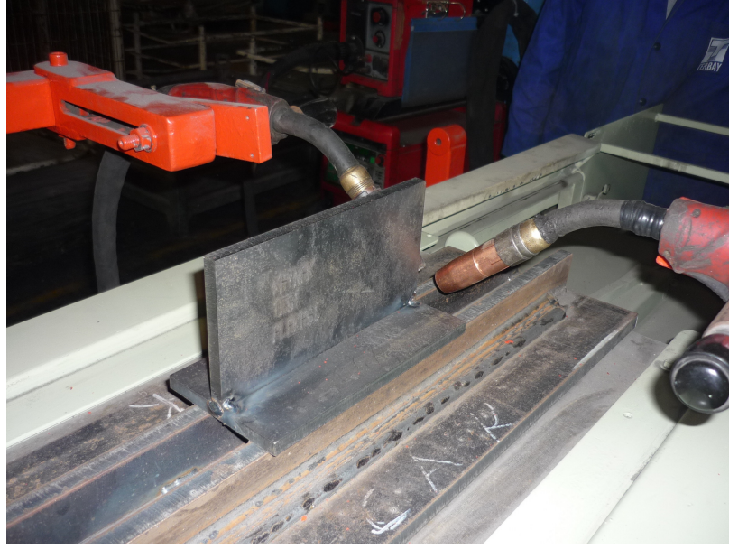
Şekil 5.7 Kaynak ön hazırlığı ve kaynak yerinin görünümü
