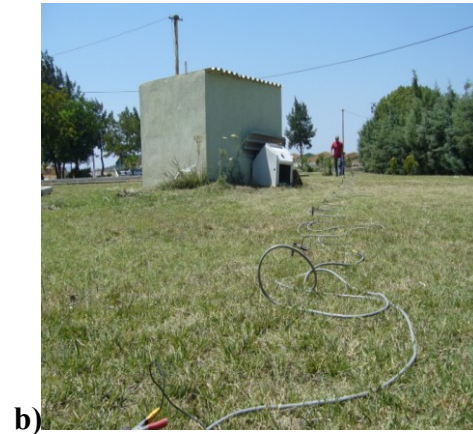
Şekil 4.56 Elektrik Özdirenç Yöntemi arazi uygulamaları ( a) DES yöntemi uygulaması. b) Özdirenç Tomografi yöntemi uygulaması).
