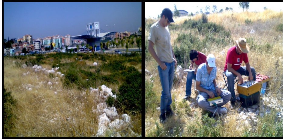
Şekil 4.39 Elektrik Özdirenç Yöntemi arazi uygulamaları ( Özdirenç Tomografi yöntemi uygulaması).
