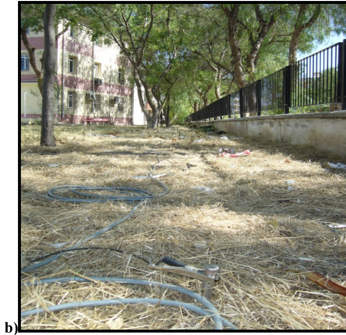
Şekil 4.53 Elektrik Özdirenç Yöntemi arazi uygulamaları
