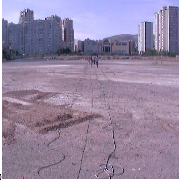
Şekil 4.113 Mavişehir istasyonunda yapılan Masw ve özdirenç tomografi çalışmalarının gösteren fotoğraflar (a-Profil 2, b-Profil 4).
