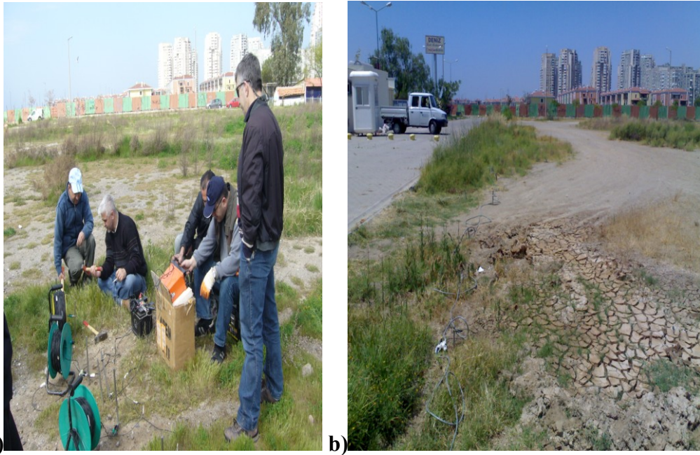
Şekil 4.50 Elektrik Özdirenç Yöntemi arazi uygulamaları ( a) DES yöntemi uygulaması. b) Özdirenç Tomografi yöntemi uygulaması).
