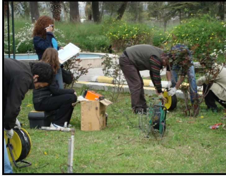
Şekil 4.27 DES yöntemi uygulaması.
