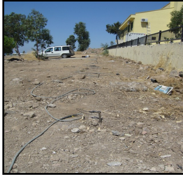
Şekil 4.30 Elektrik Özdirenç Yöntemi arazi uygulamaları (a) DES yöntemi uygulaması. b) Özdirenç Tomografi yöntemi uygulaması).
