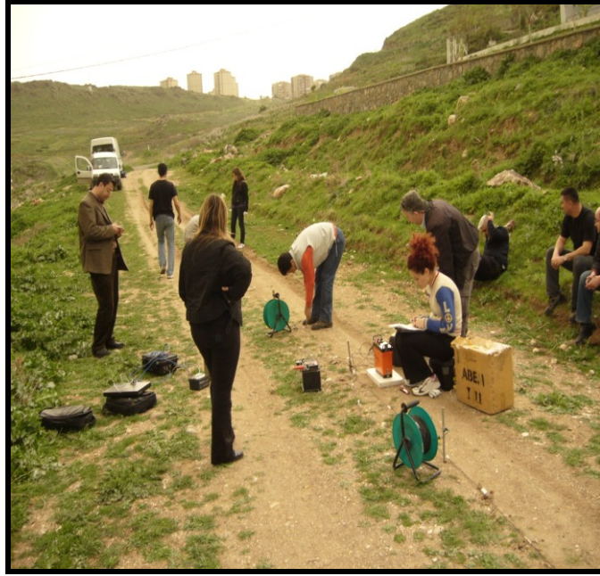
Şekil 4.59 DES yöntemi uygulaması.
