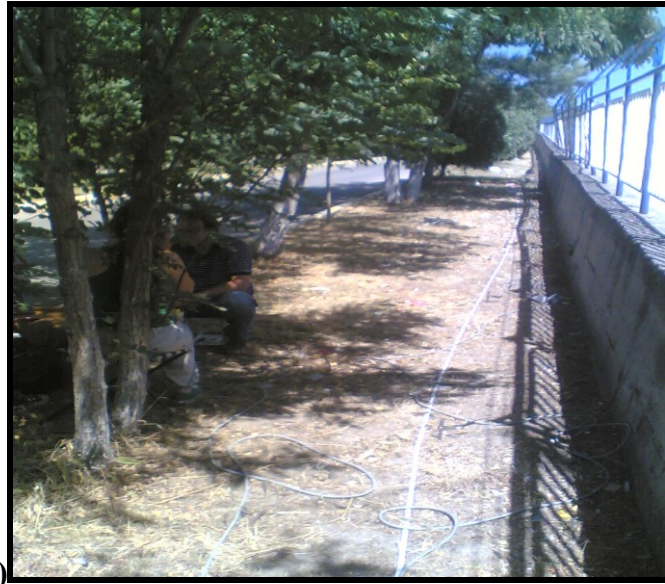
Şekil 4.24 Elektrik Özdirenç Yöntemi arazi uygulamaları ( a) DES yöntemi uygulaması. b) Özdirenç Tomografi yöntemi uygulaması).
