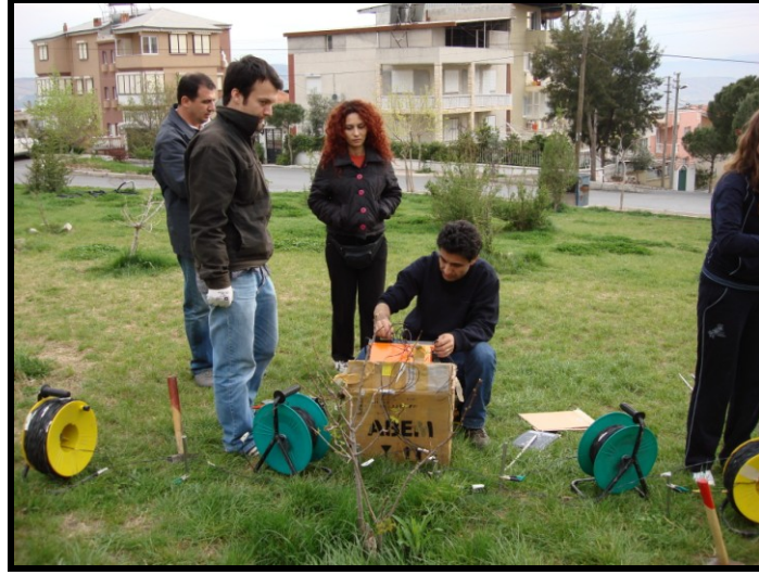
Şekil 4.47 DES yöntemi uygulaması.
