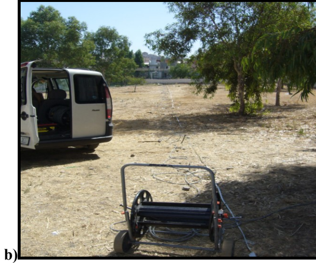
Şekil 4.61 Elektrik Özdirenç Yöntemi arazi uygulamaları (a) DES yöntemi uygulaması. b) Özdirenç Tomografi yöntemi uygulaması).
