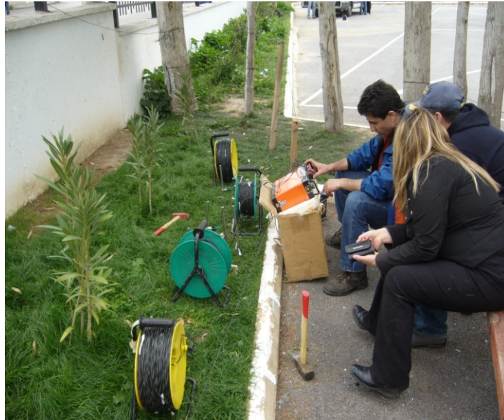
Şekil 4.33 DES yöntemi uygulaması
