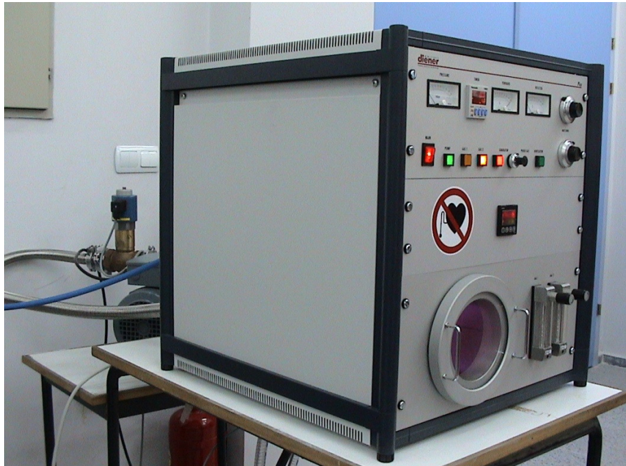
Şekil 2.1 Baratron Sistemli PICO RF (Radyo frekansı - 13,56 MHz) plazma Cihazı
