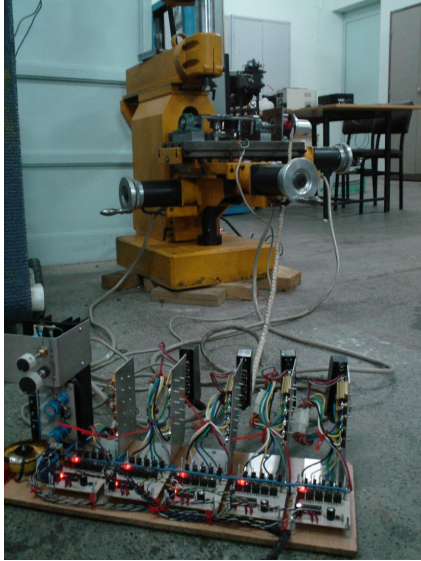
Şekil 7.1 Beş eksen tezgahın çalıştırılması
