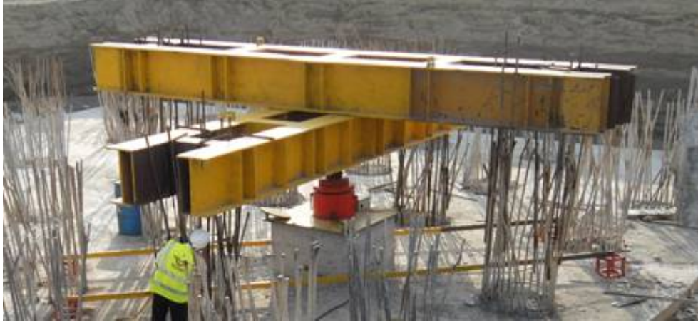
Şekil 10.1 Kazık yükleme testi 4 farklı kazığı çekme kazık olarak, ortadaki kazığı ise oturma kazığı olarak tayin edildiği şeklinin genel görünümü
