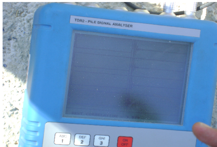
Şekil 11.2 Kazık a gönderilen sismik bir dalga bir adet sinyal alıcı (jeofon) suretiyle dalganın kazık içinde ki yayılımı ve dağılımı incelenmektedir. Bu dalganın hız-zaman değerleri elde edilerek basit bir sismik mantığı ile kazık bütünlülüğü ve sürekliliği tespit edilmektedir.
