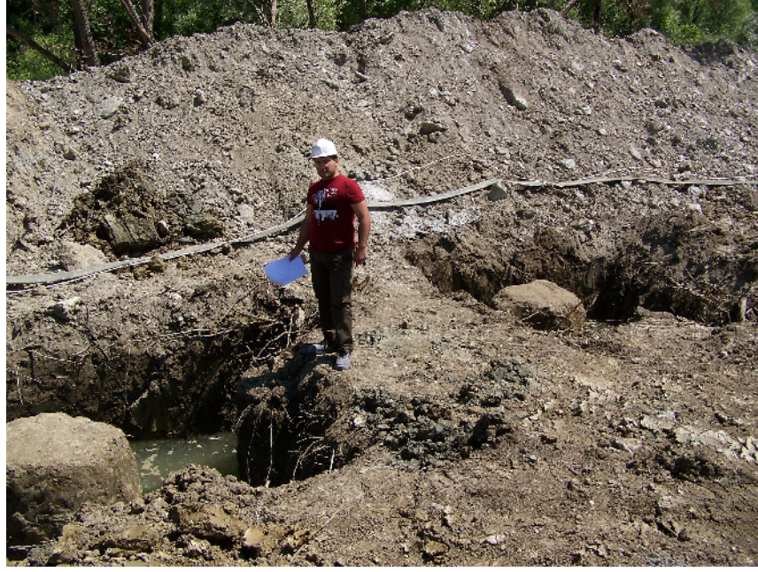
Şekil 7.1 Pamukova bölgesinde yapılan test kolonlarının 7 gün sonra açılması
