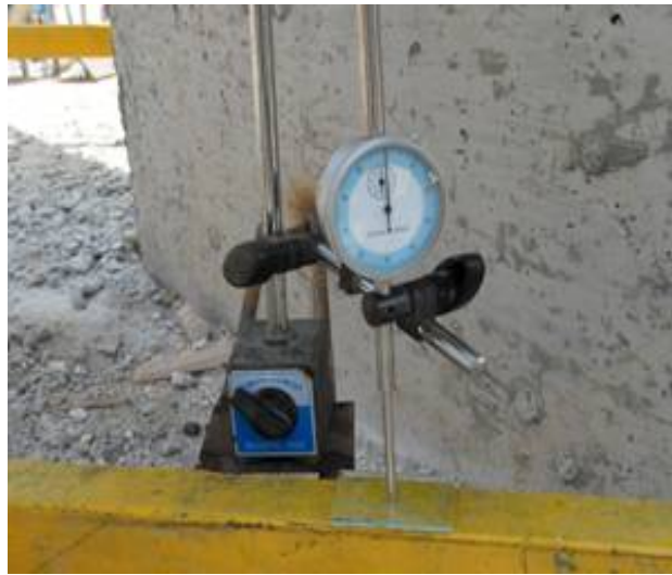
Şekil 10.2 Seçilen bir kazığa yük uygulanması ve kalibre edilmiş 0.01 mm hassasiyetli oturmaya gösteren ölçüm saati
