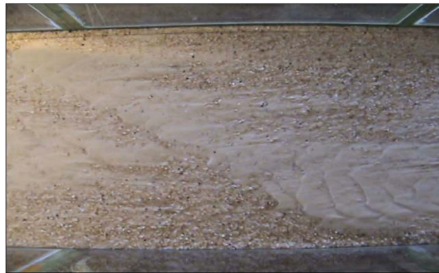
ı) 11-12m arasındaki oluşan kum dalgaları
