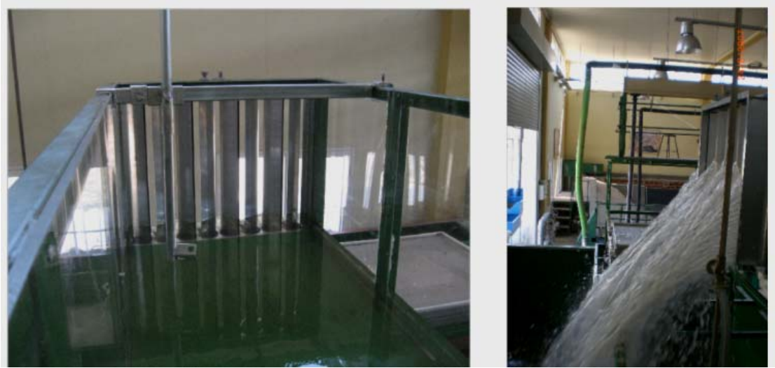
Şekil 3.5 Kanalın mansabındaki panjur sistemi
