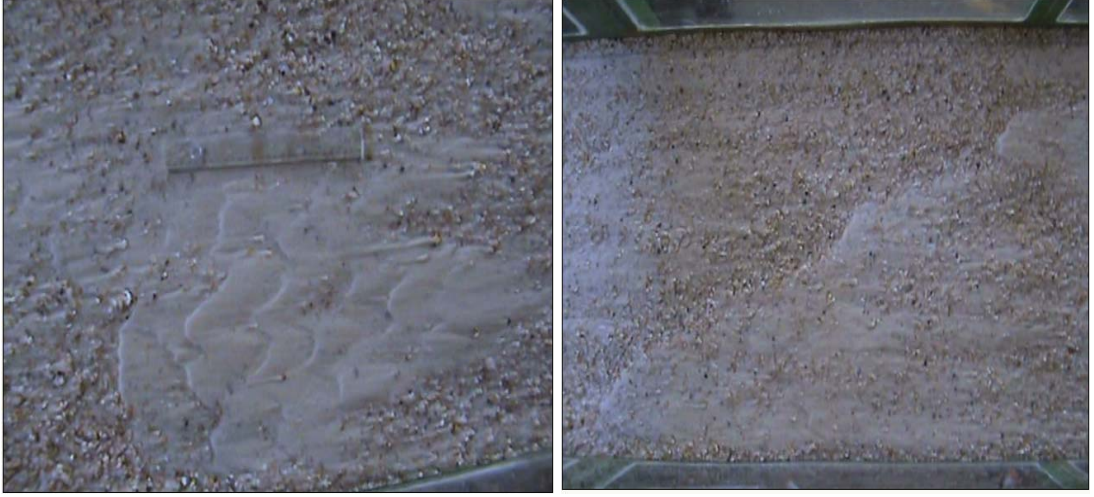
(a) 13-14. m'de oluşan kum dalgacıkları çünkü dalga boyları \lambda = 10\text{cm} civarında ince malzeme dane çapı ile alakalı d_{50} = 0,45\text{ mm} 'dir. (b) 16-17. m'de oluşan kumullardır. çünkü dalga boyu \lambda = 90\text{ cm} dir. su derinliğini birkaç katı büyüklüğündedir. Kumul yüksekliği 2 cm civarındadır.
