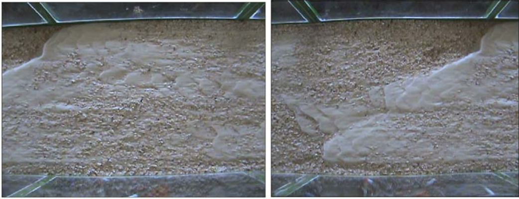
a) 6-7 m’deki kumul ve üzerindeki kum dalgacıkları b) 7-8 m’deki oluşan taban şekli
