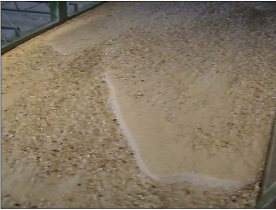
g) 93,5 lt/s debiden sonra oluşan 3D kumullar
