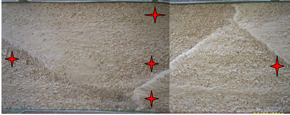
e)12-13 ve 14'üncü metredeki transducerların yerleşimi
