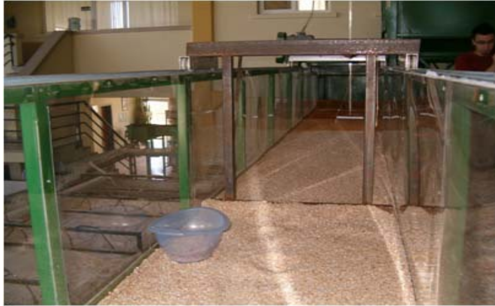
Şekil 3.19 Taban malzemesi yüzeyinin oluşturduğu eğiminin belli bir değerde tutulmasını sağlayan sistem
