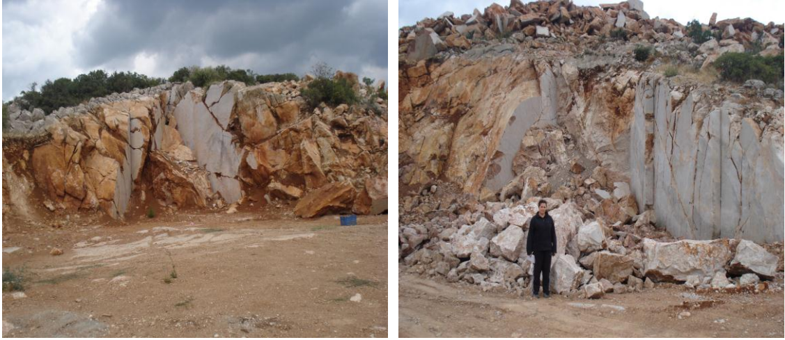
Şekil 4.74 Üretim yapılan çatlaklı ve kırıklı mermerler
