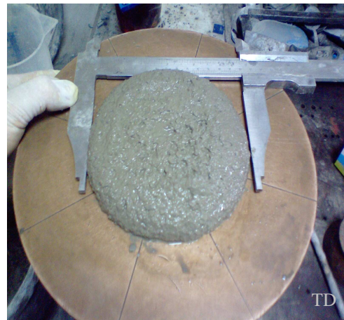
Şekil 5.6 Yayılma çapı ölçümü
