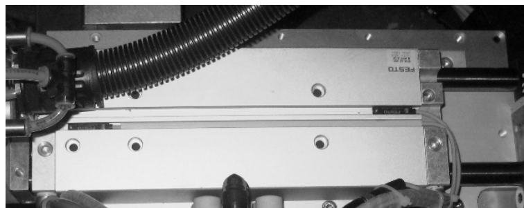
Şekil 6.16 Konum algılayıcının DFM silindire takılmış olarak gösterimi
