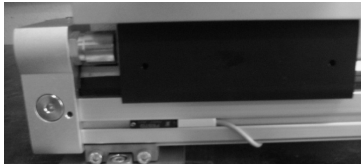
Şekil 6.15 Konum algılayıcının milsiz DGC silindire takılmış olarak gösterimi
