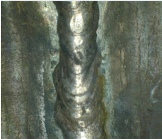
Şekil 6.5 Numune 1 kaynak dikiş görüntüsü. (Doğru akım elektrod negatif kutuplama)
