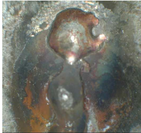
Şekil 6.6 Numune 6 kaynak dikiş görüntüsü. (Doğru akım elektrod pozitif kutuplama)
