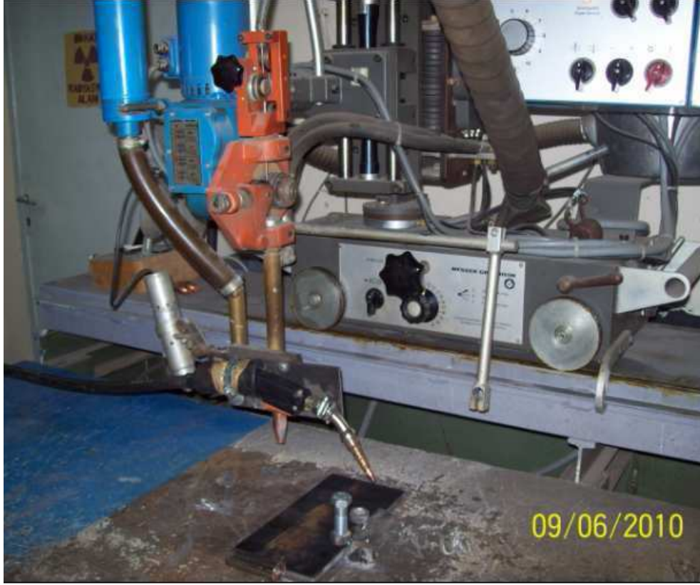
Şekil 6.11 MIG kaynağı testlerinde kullanılan düzeneğe ait fotoğraf
