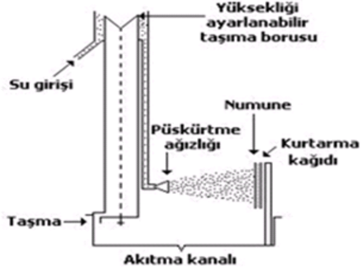
Şekil 1.34 AATCC yağmur testi(Horrocks ve Anand, 2000)
