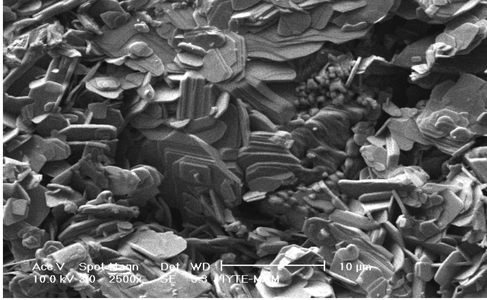
Şekil 5.14 \text{Bi}_{1.7}\text{Pb}_{0.3}\text{Sr}_2\text{Ca}_2\text{Cu}_{3-x}\text{Mg}_x\text{O}_y ( x=0,00 ) SEM görüntüsü
