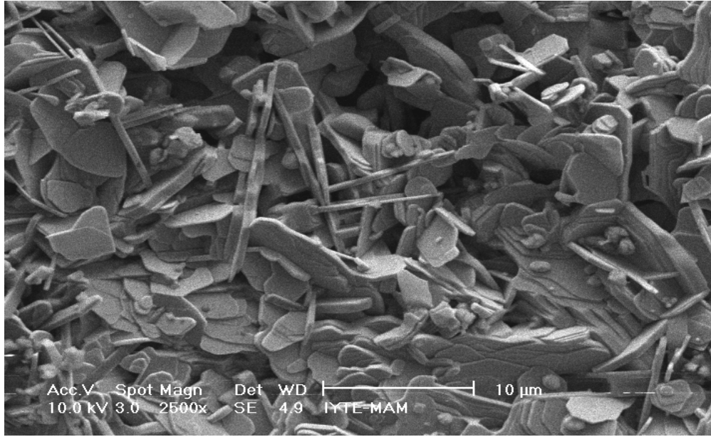
Şekil 5.17 \text{Bi}_{1.7}\text{Pb}_{0.3}\text{Sr}_2\text{Ca}_2\text{Cu}_{3-x}\text{Mg}_x\text{O}_y (x=0,15) SEM görüntüsü
