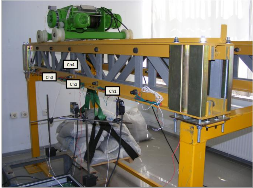
Şekil 5.12 Deneyel gerilme analizinde ölçümler için yerleştirilmiş gerinim ölçerler
