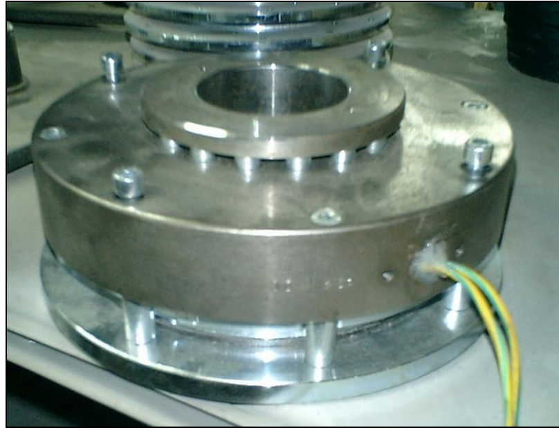
Şekil 4.12 Fren sistemi montajı yapılmış hali(C. Kara, 2008 s.101).
