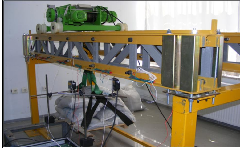
Şekil 5.10 Deneysel gerilme analizi için hazırlanmış prototip
