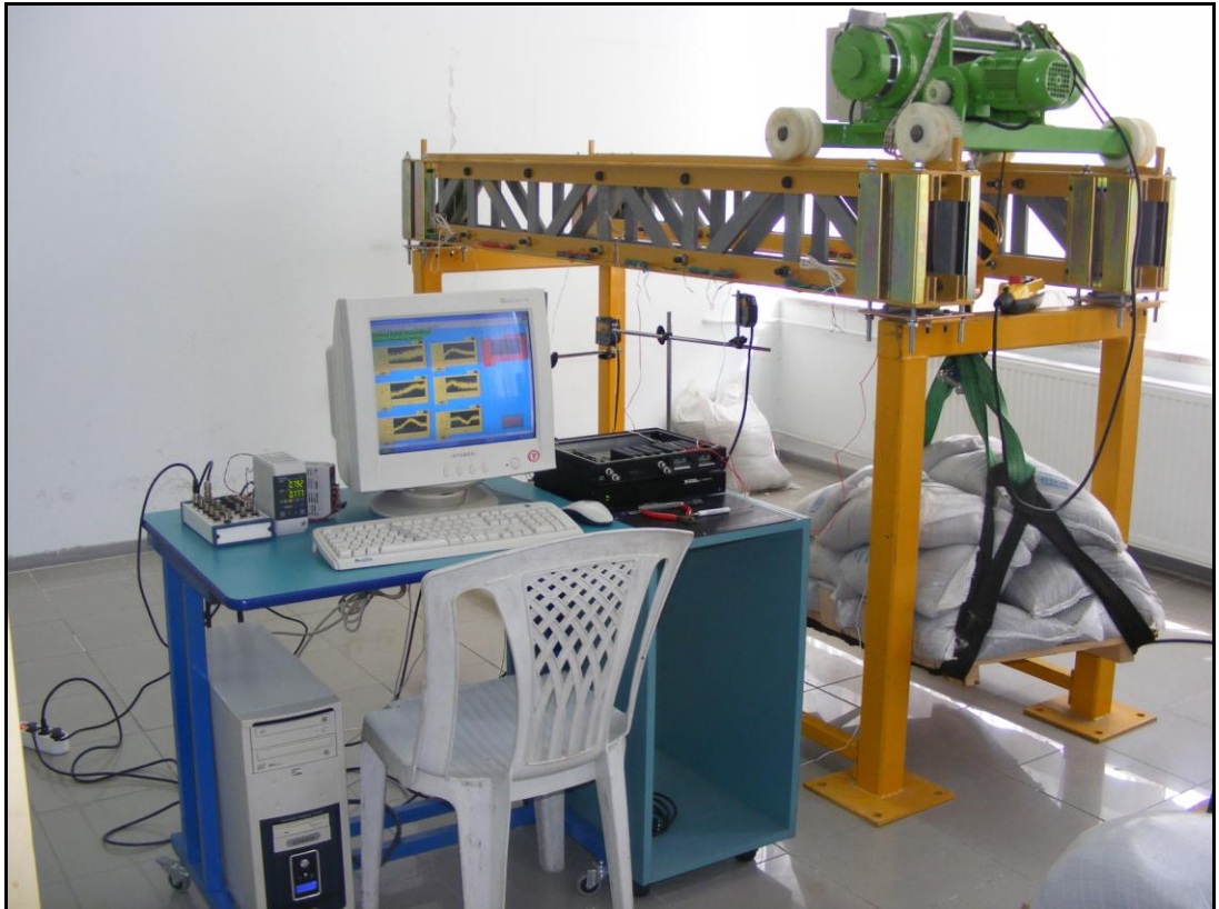
Şekil 5.17 Dinamik gerilme testleri için hazırlanmış deney düzeneği
