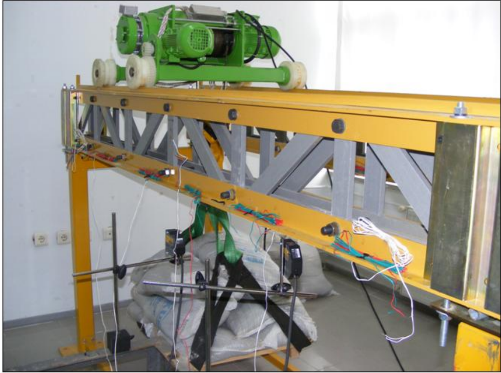
Şekil 4.5 “Double T” kutu profillerin sehpa üzerine montajı
