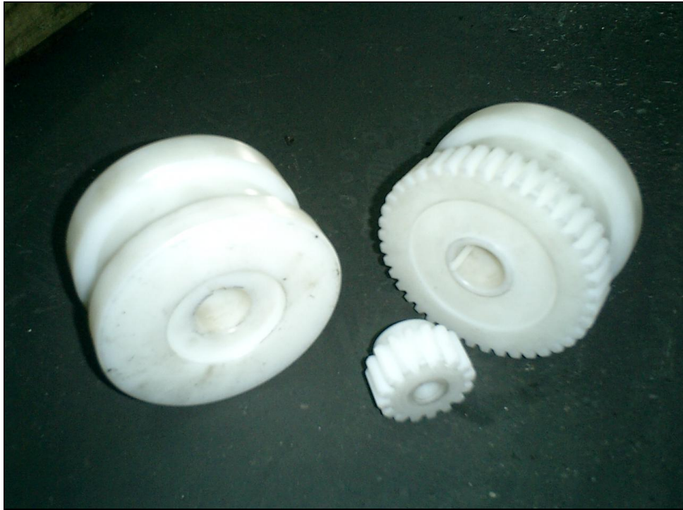
Şekil 4.13 PA6 malzemeden imal edilen pinyon ve araba tekerlekleri(C. Kara, 2008 s.103).
