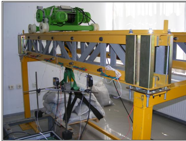
Şekil 4.15 Kirişlerin sehpa üzerine montaj edilmiş hali
