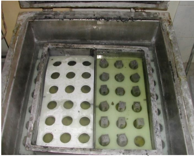
Şekil 7.6 ASR harç çubuğu örneklerinin 80°C sıcaklıkta NaOH çözeltisi içinde kür edilmesi ve boy değişimlerinin ölçülmesi.
