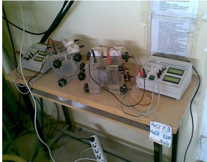
Şekil 7.8 Klor Geçirirliliği deneyi düzeneği.
