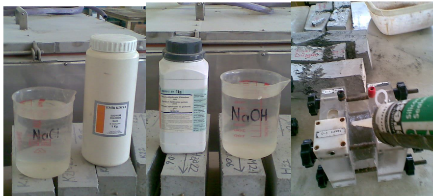
Şekil 7.9 NaCl ve NaOH çözeltileri ve örneğin deneye hazırlanması.
