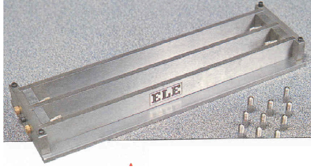
Şekil 7.5. ASR deneyi için kullanılan harç çubuğu kalıpları.
