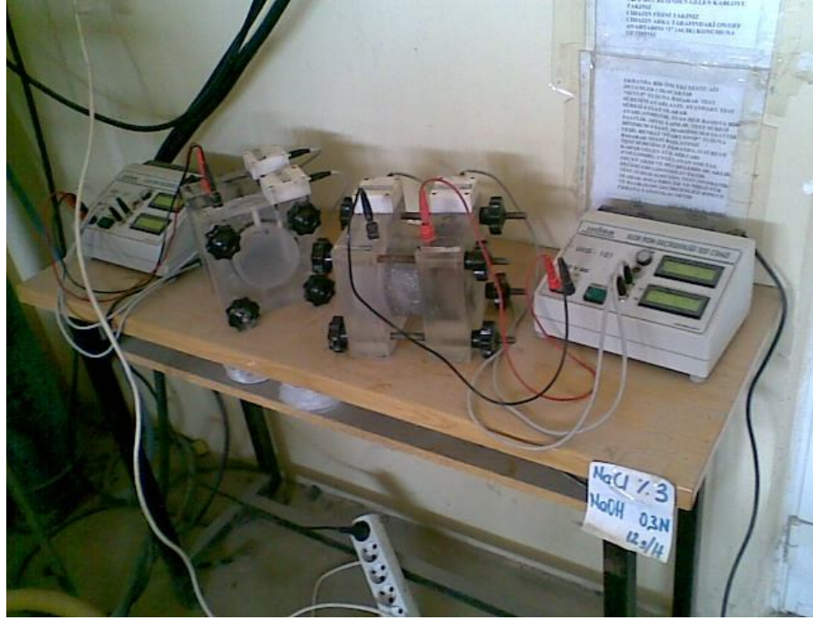
Şekil 5.2 Hızlandırılmış klor geçirimsizliği deneyi düzeneği.
