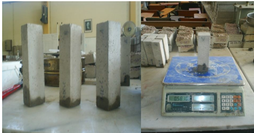
Şekil 7.11 Su emme deneyine bırakılan örneklerin tartılması.
