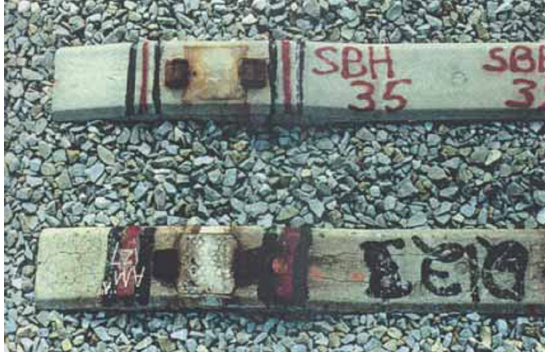
Şekil 3.1 Hasar görmemiş travers (üst) ve görmüş traversler (alt). (Hasarlı örnekte çatlaklar uzun kenara paralel olarak gelişmiştir.)
