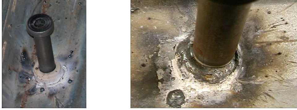
Şekil 2.8 Kaynaklanmış başlıklı kayma bağlantısı
