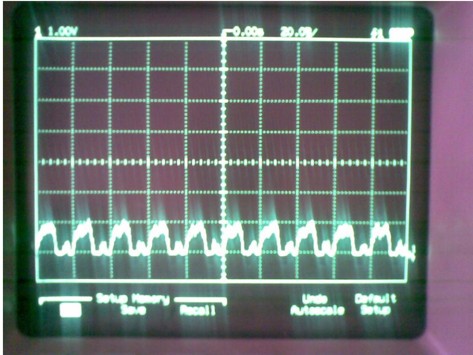
Şekil 4.1 Kolda kasılma yokken osiloskop görüntüsü (ADC girişi)
