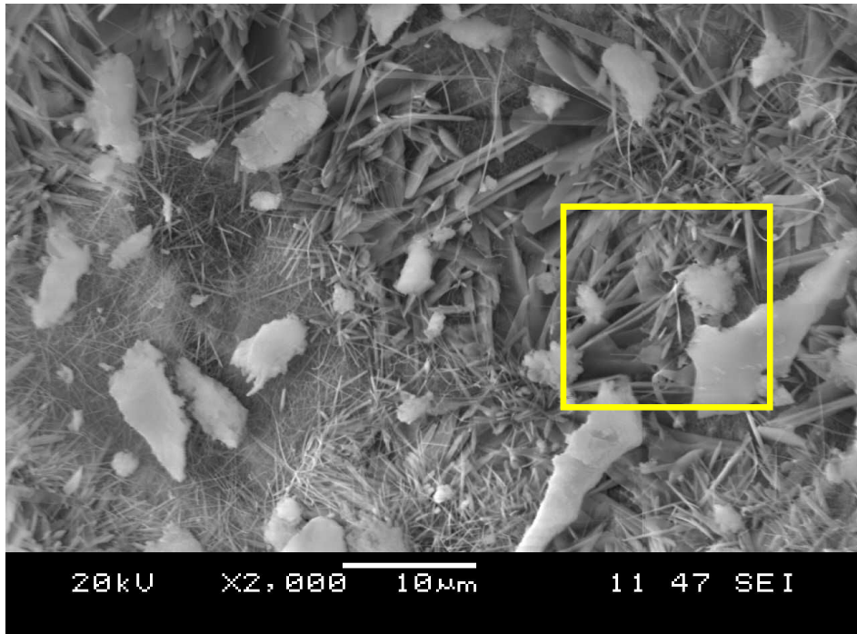
Şekil 10.35 NL serisinde 1 MPa basınçta 12 saat kürde EDS analiz bölgesi
