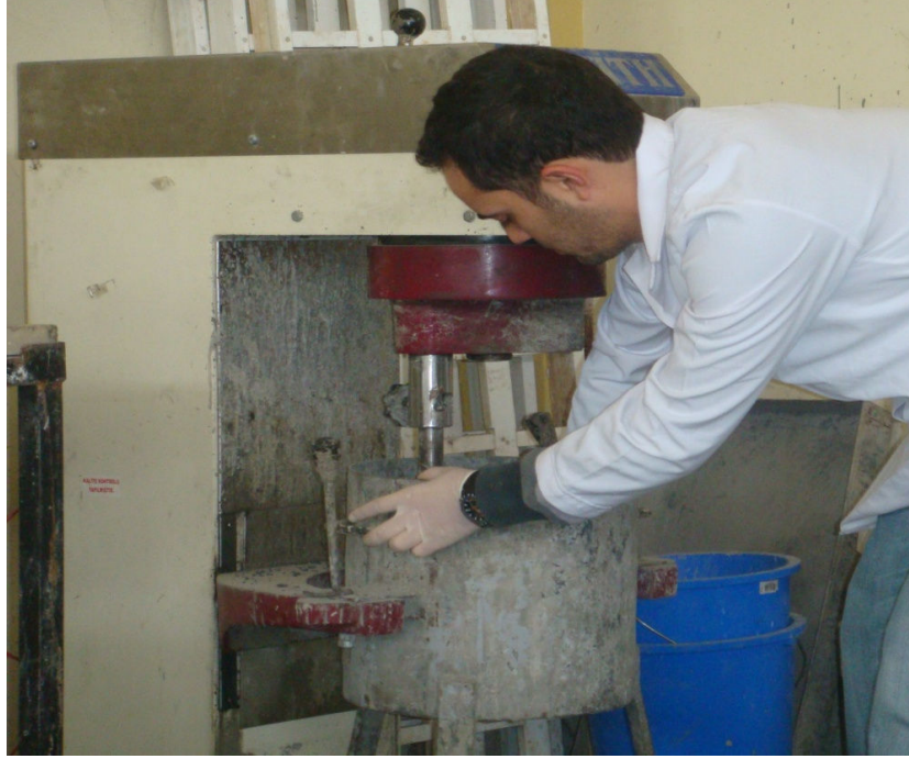
Şekil 5.4 Karıştırma işleminde kullanılan mikser ve homojen bir karışım elde etmek için kovada kalan karışımın alt üst edilmesi
