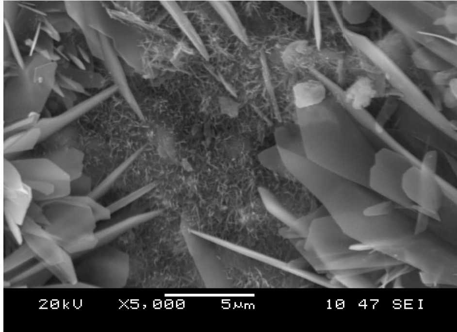
Şekil 10.38 NL kodlu 1 MPa basınçta 24 saat kür edilmiş numunenin içyapısı
