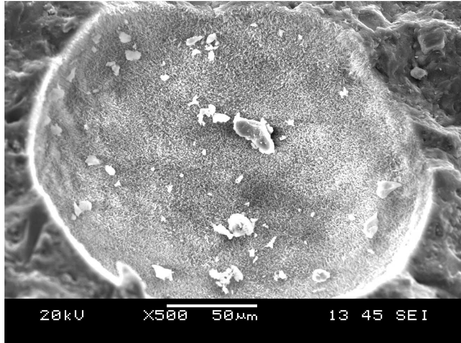
Şekil 10.64 SDL kodlu, 1 MPa kür basıncında 6 saat kür edilmiş numunenin iç yapısı
