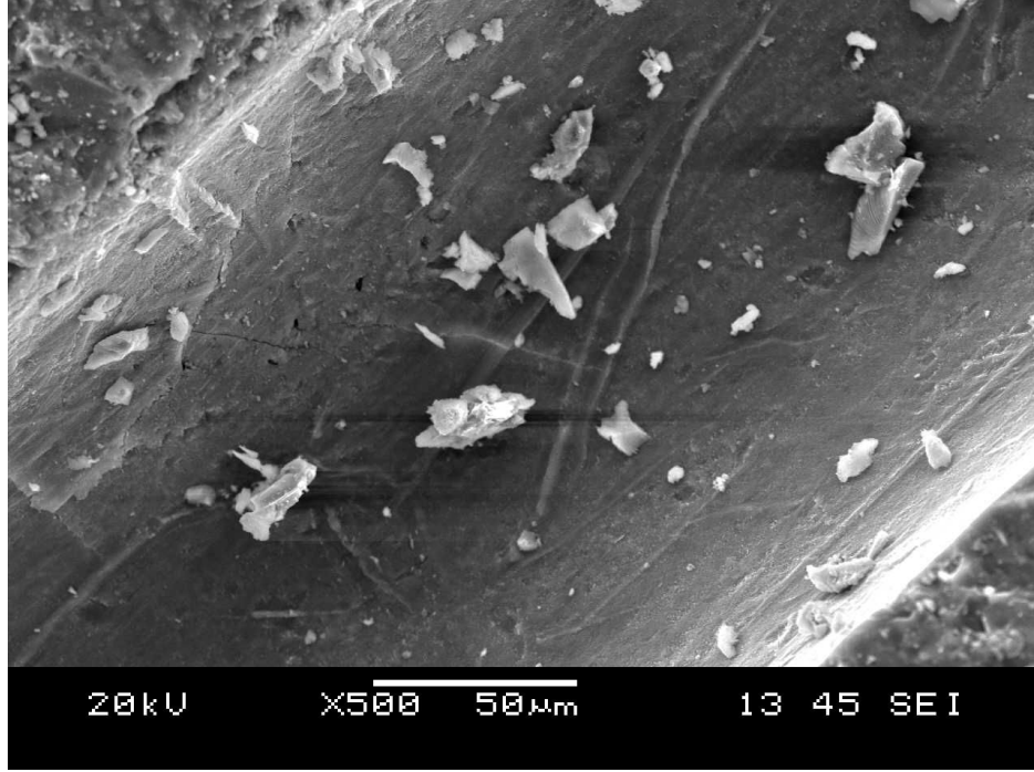
Şekil 10.63 SDL kodlu (1 MPa – 6 saat kür) lif sıyrılma bölgesi
