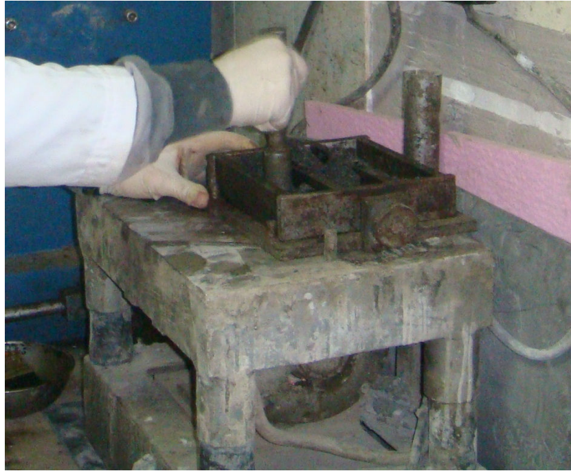
Şekil 5.5 Deneyde kullanılan kalıp ve sarsma tablası, beton karışımının karıştırılması sırasında sarsılması ve tokmaktanması
