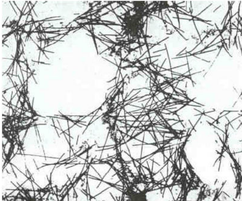
Şekil 3.9 Çelik liflerin betonda süreksiz dağılımı
