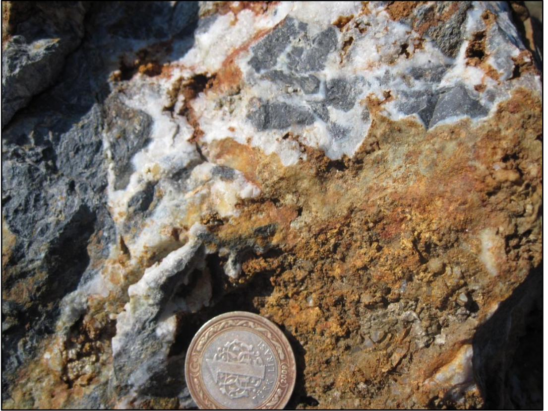
Şekil 2.13 Çalışma alanında gözlenen küçük ölçekli mostralar şeklindeki hidrotermal breşler ve beraberindeki karbonat ornatım dokusu izlerine ait el örneği.
