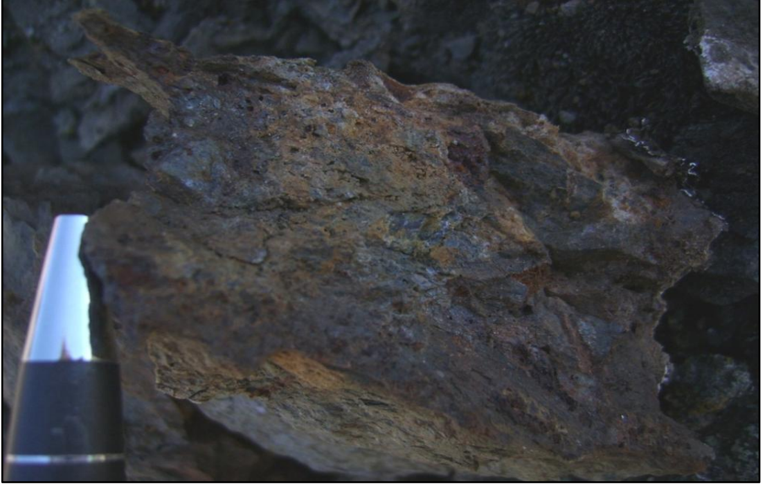
Şekil 2.12 Çalışma alanında hematit-limonit-silis breşleri şeklinde gözlenen cevherleşme.
