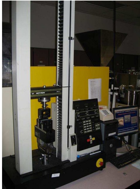
Şekil 2.10 Instron 4411 Çok amaçlı Mukavemet Ölçeri
