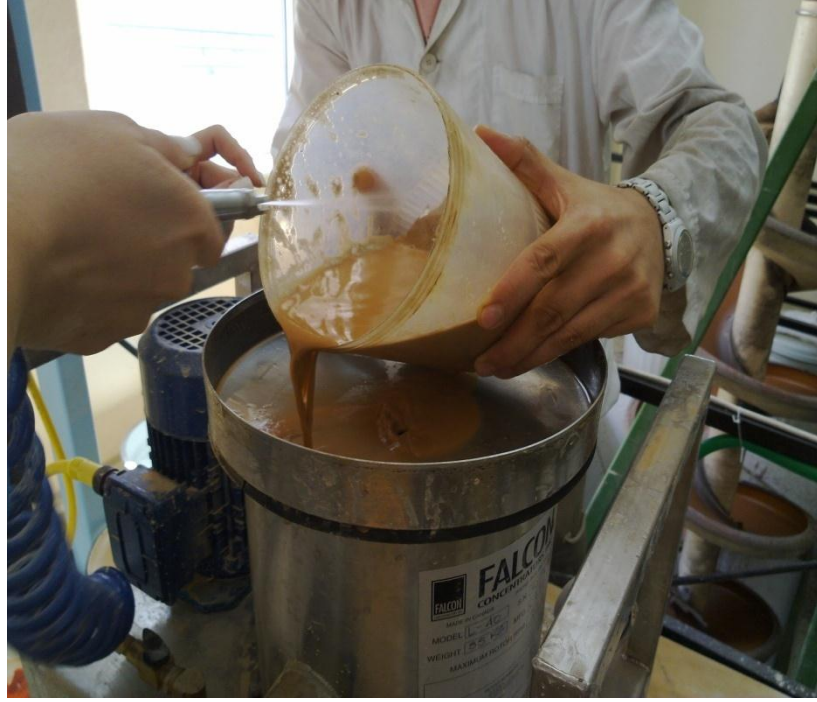
Şekil 3.27 Falcon konsantratörde zenginleştirme işlemi
