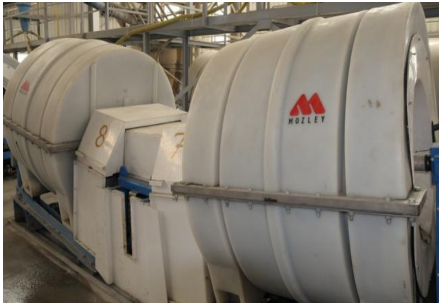
Şekil 2.8 Endüstriyel çapta Mozley multi gravite ayırıcı (Pınar Madencilik, 2010)
