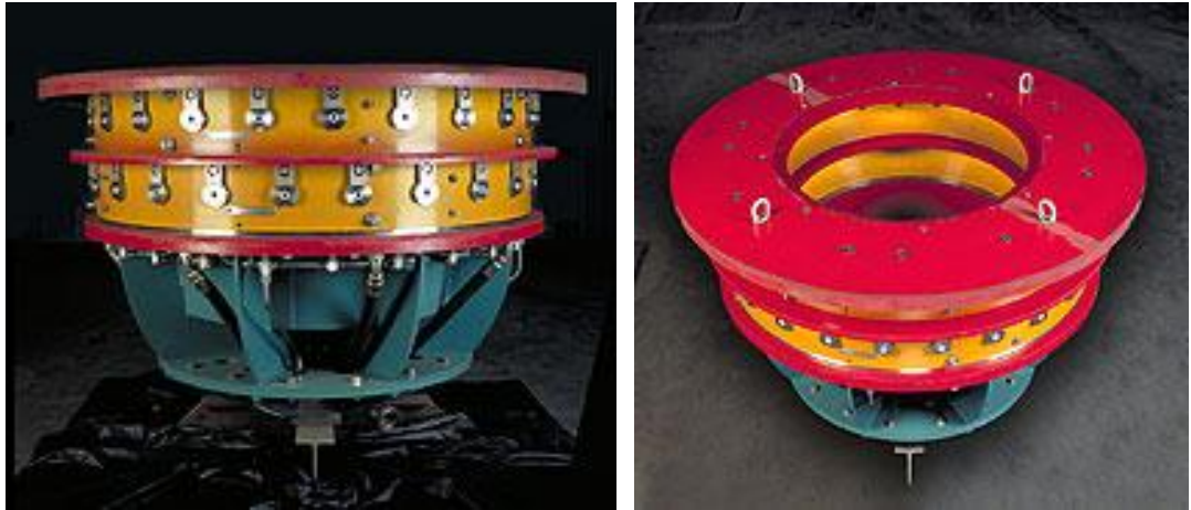
Şekil 2.20 Sürekli çalışan Knelson seperatörlerin konik çanakları
