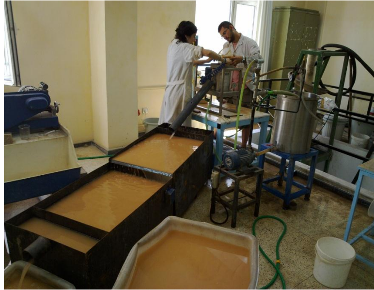
Şekil 3.28 Falcon konsantratörde zenginleştirme İşlemi
