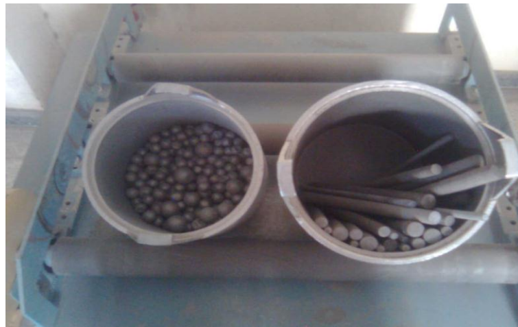
Şekil 3.19 Değirmen içindeki bilya ve çubukların görünümü
