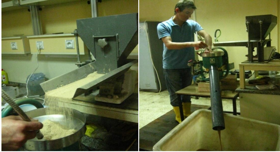
Şekil 3.20 Knelson konsantratörde zenginleştirme işlemi
