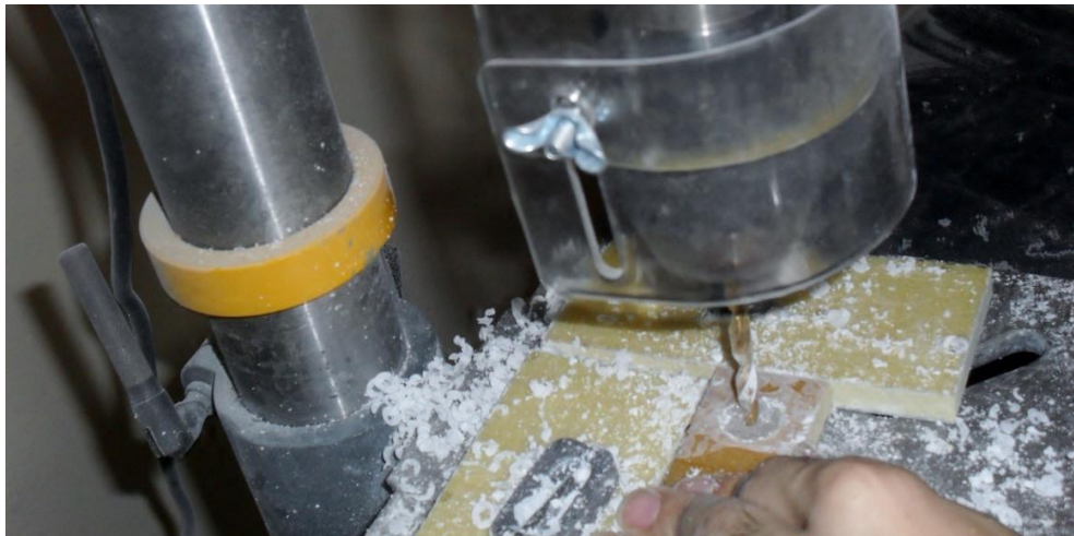
Şekil 4.10 Pim deliklerinin delinmesi işlemi
