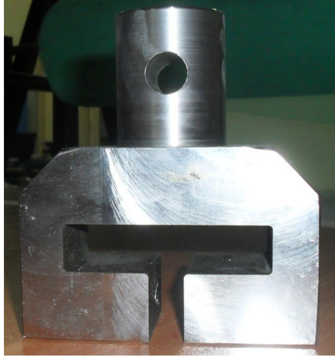
Şekil 4.4 İmal edilmiş olan numune bağlantı aparatı
