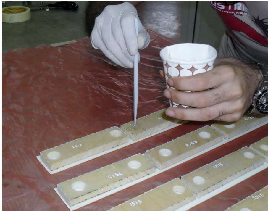
Şekil 4.8 Deliklerin dolgu ile doldurulması işlemi
