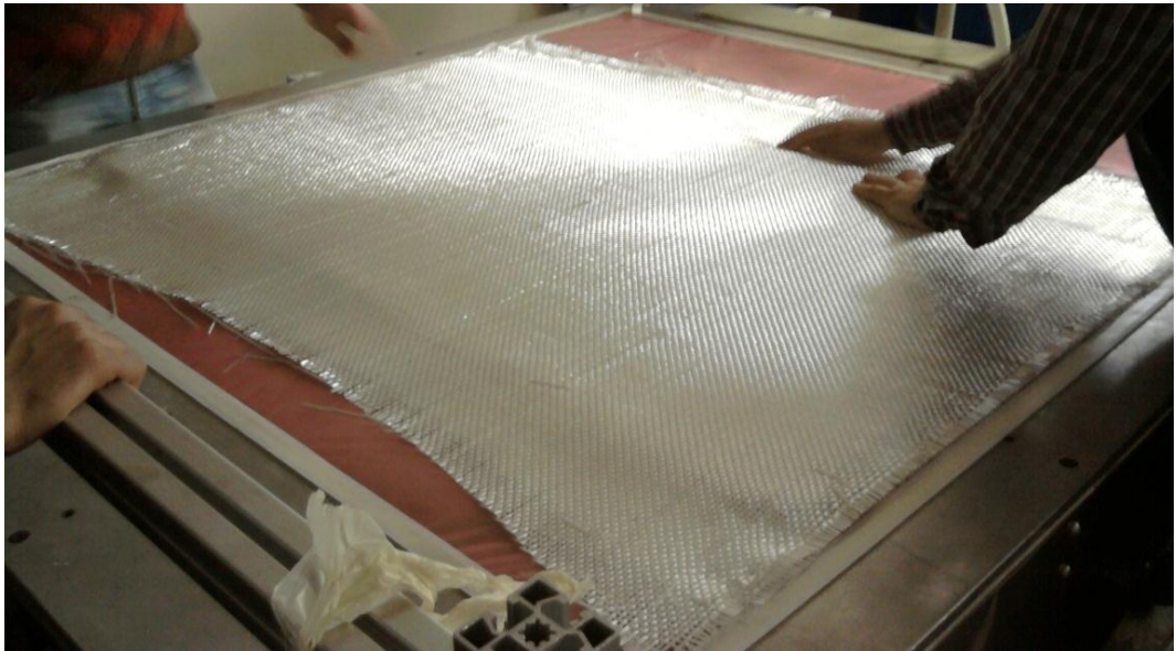
Şekil 3.8 Elyafın PVC köpüğün üzerine yerleştirilmesi
