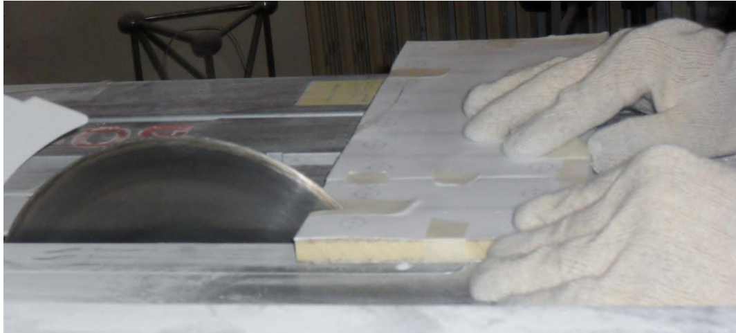
Şekil 4.5 Sandvi kompozit plakanın testerede kesilmesi
