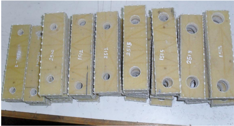
Şekil 4.7 İlk delik delme işlemi uygulanmış olan numuneler
