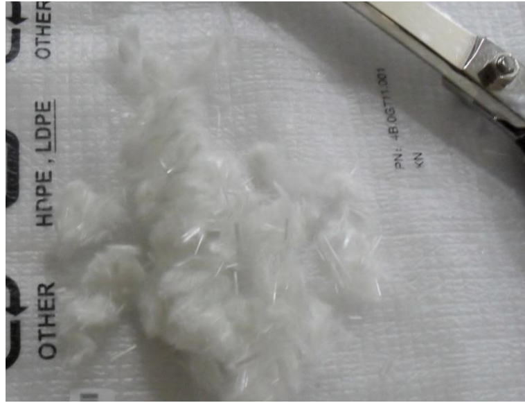
Şekil 4.6 Dolgu malzemesi için hazırlanmış olan kırılmış cam elyaf
