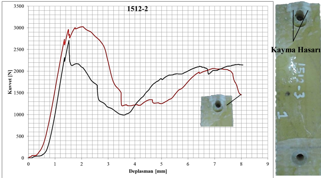
Şekil 5.7 1512-2 kodlu numunelerin kuvvet - deplasman grafiği ve meydana gelen dolgu hasarı
