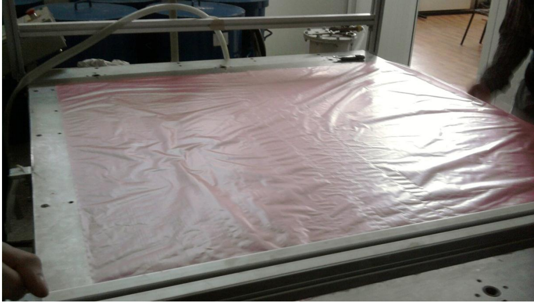
Şekil 3.5 Kalıp ayırıcı olarak kullanılan polilefin filmin serilmesi
