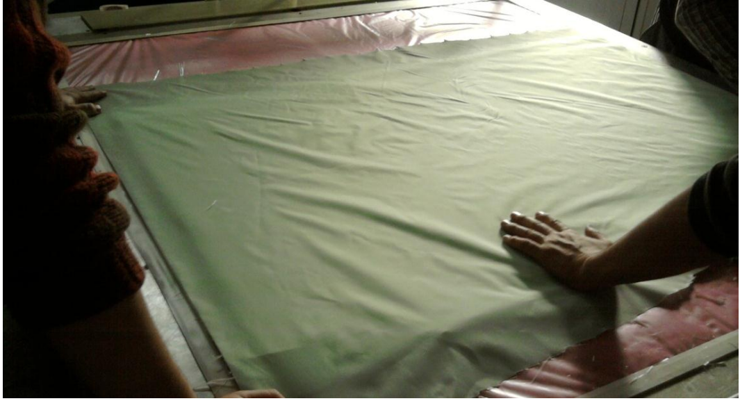
Şekil 3.9 Soyma kumaşının cam-elyaf üzerine yerleştirilmesi
