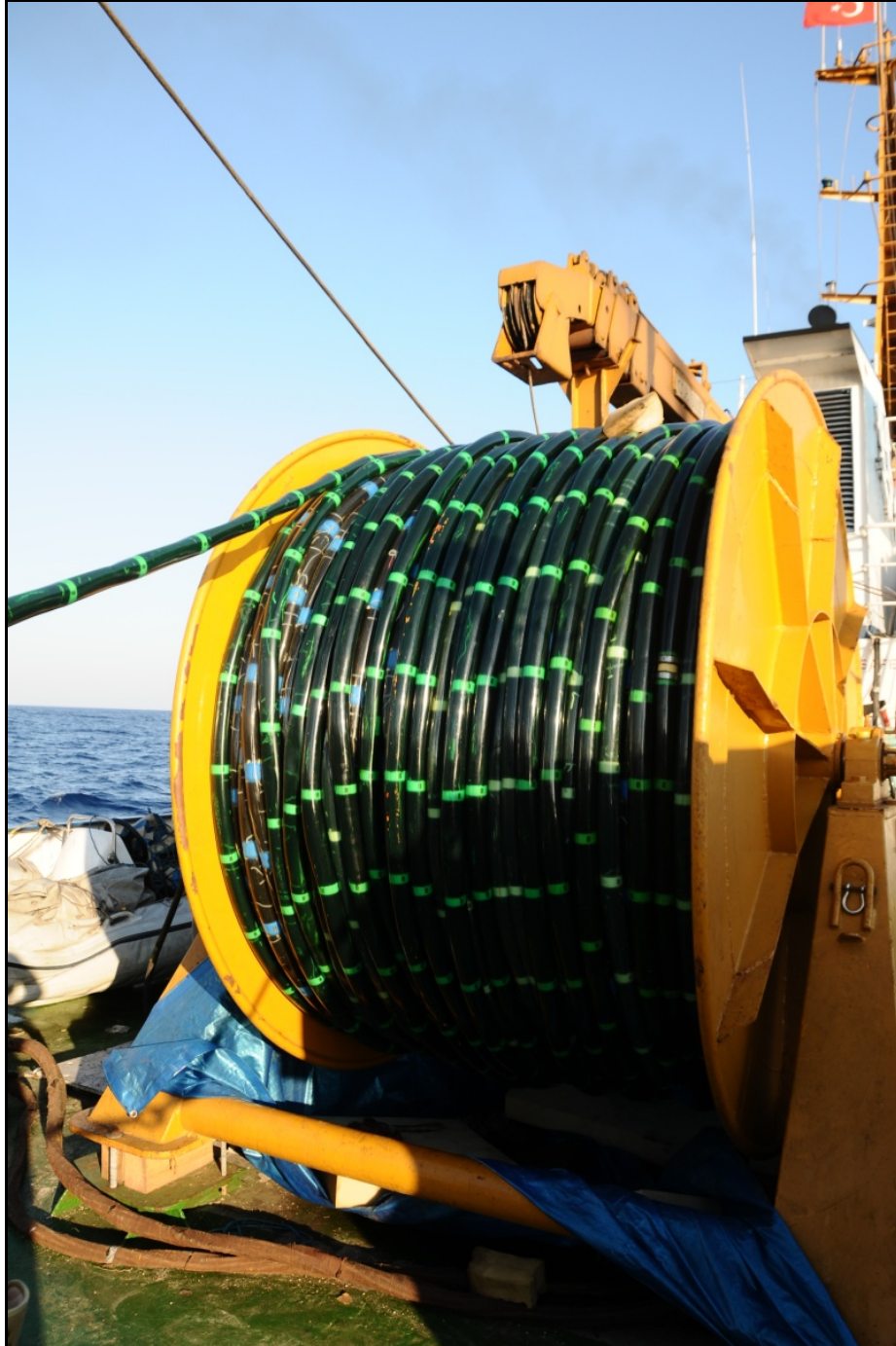
Şekil 5.3 Çalışmada kullanılan sismik alıcı (streamer). Streamerın içinde hidrofon grupları yoğunluğu sudan küçük olan bir sıvı içerisindedir
