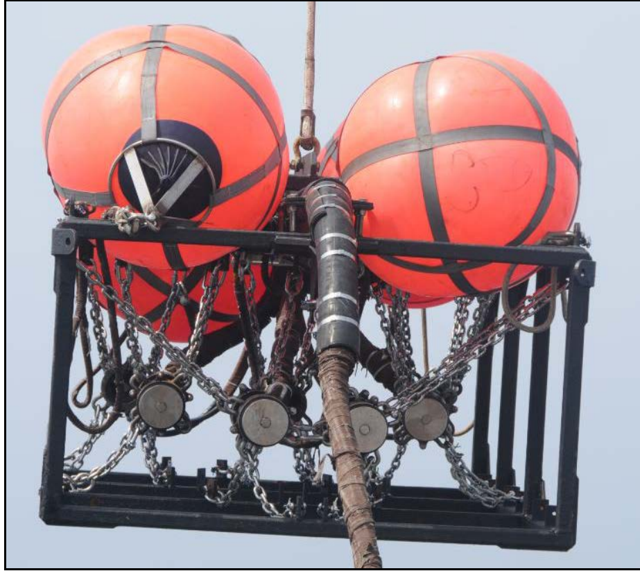
Şekil 5.2 Veri toplama için kullanılan sleeve gun düzeneği. Farklı hacimli yedi adet hava tabancasının birleşmesinden oluşur ve amaç bubble etkisinin azaltılmasıdır
