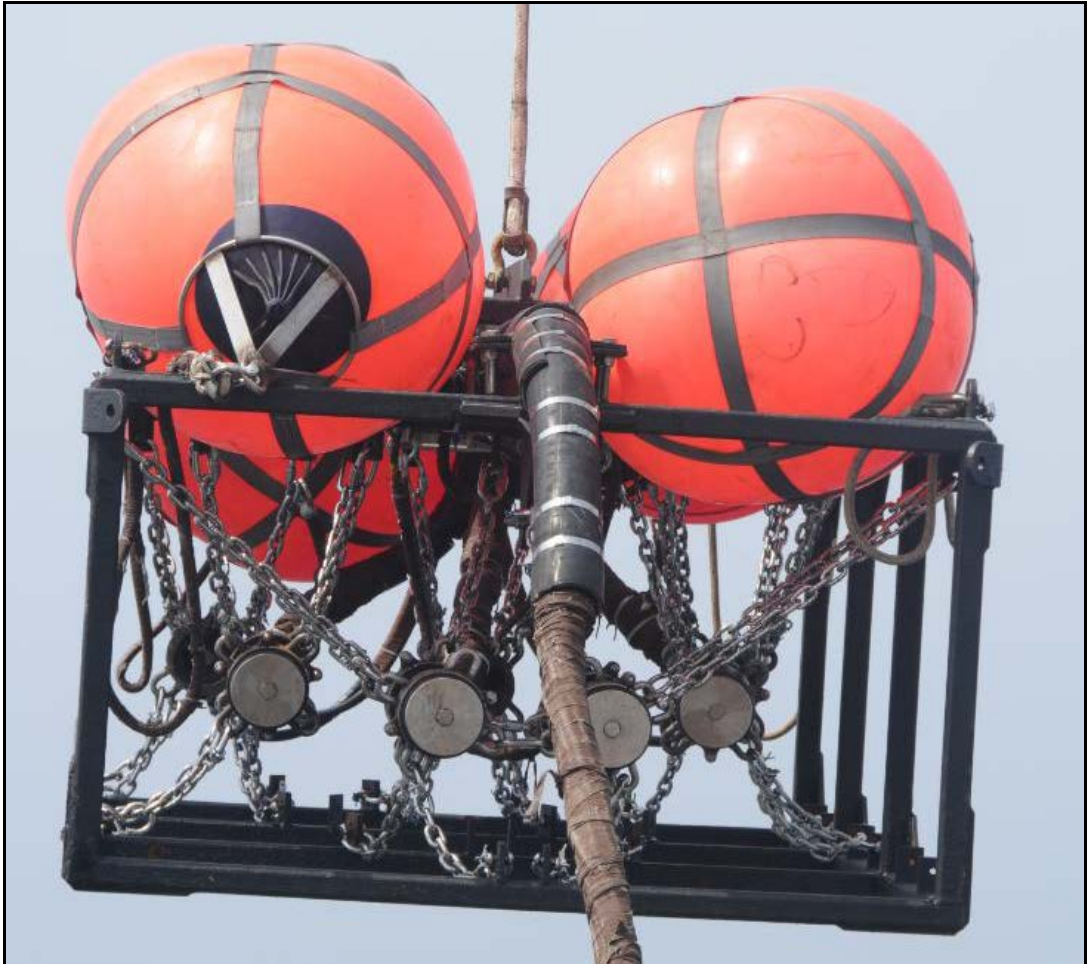
Şekil 4.6 2008 Kilikya Baseni çalışmasında kullanılan çoklu hava tabancası düzeneği. Amaç balon etkisini sönümlemek ve ana sinyalin genliği arttırmaktır
