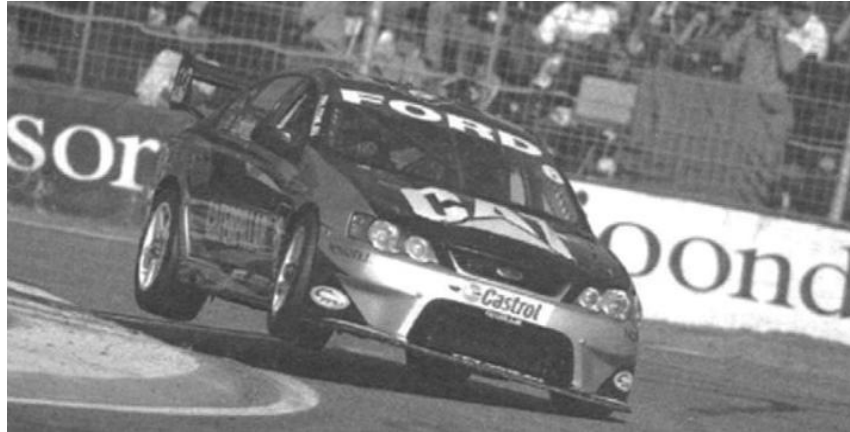
Şekil 2.4 Devrilme öncesi viraj yük durumu; yarış arabasında görüldüğü gibi keskin bir virajı dönerken dinamik tekerlek yüklerinin sadece dış tekerlek üzerine gelmesi durumudur (Blundell ve Harty, 2004).
