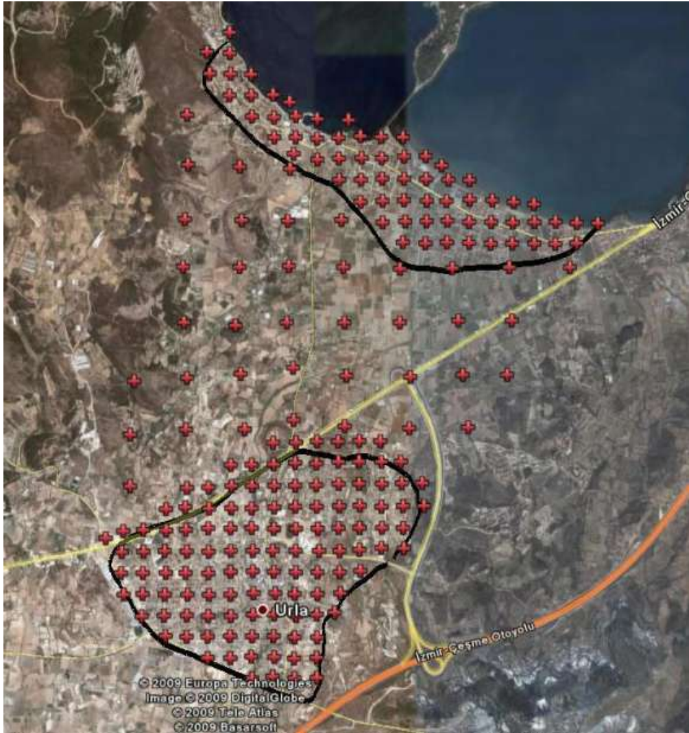
Şekil 4.2 Yerleşimin yoğun olduğu bölgelerde ölçüm aralığı 200-250m, seyrek olduğu bölgelerde ölçüm aralığı 500m olacak şekilde noktaların uydu görüntüsü
