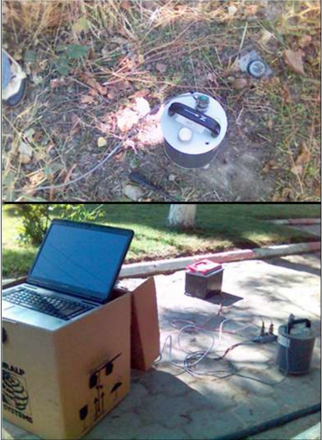
Şekil 4.4 Mikrotremor ölçüm düzeneği ve kullanılan donanımlar (Güralp, CMG-6TD sismometresi)
