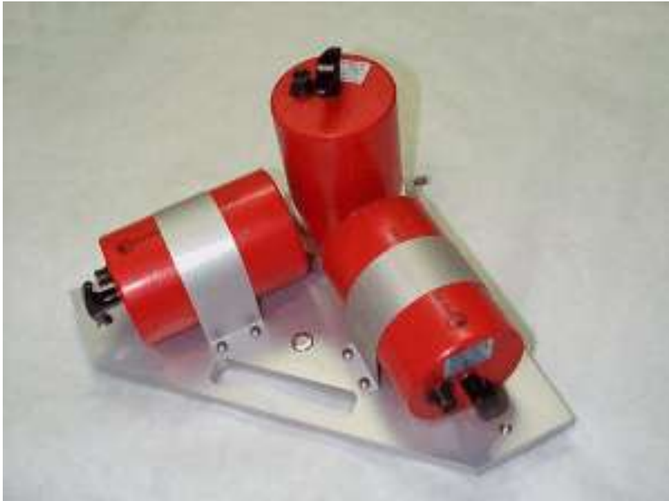
Şekil 3.5 Mikrotremor ölçümlerinde kullanılan geniş band aralıklı üç bileşenli sismometreler
