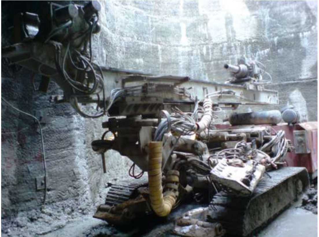
Şekil 2.9 4 inçlik boru deliklerinin delinebilmesi için kullanılan makine
