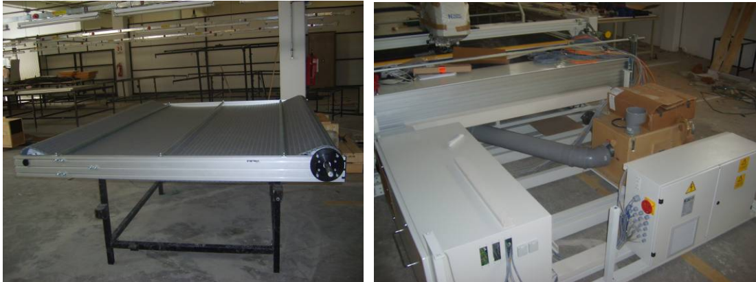
Şekil 3.67 Toplama bandı, vakum kasası ile vakum torbası arası bağlantı (Çekim ve düzenleme: M.S.Ç.)
