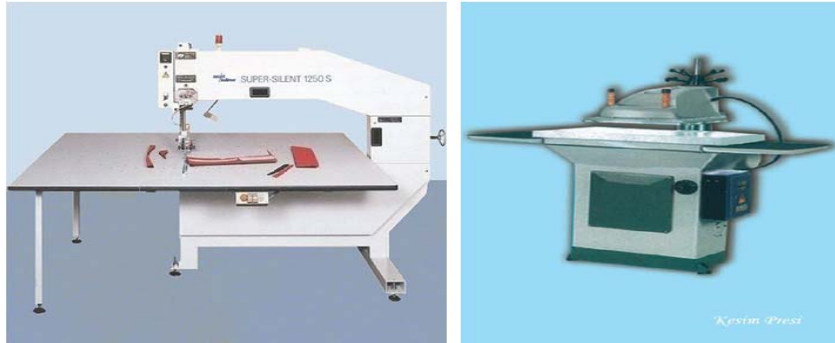
Şekil 1.7 Malzemeyi hareket ettirerek yapılan kesim: Hızar, giyotin makinesi
