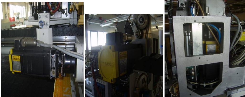
Şekil 3.30 x, m (bıçak), c (göbek-eğrisel kesim içi) motorları (Çekim ve düzenleme: M.S.Ç.)
