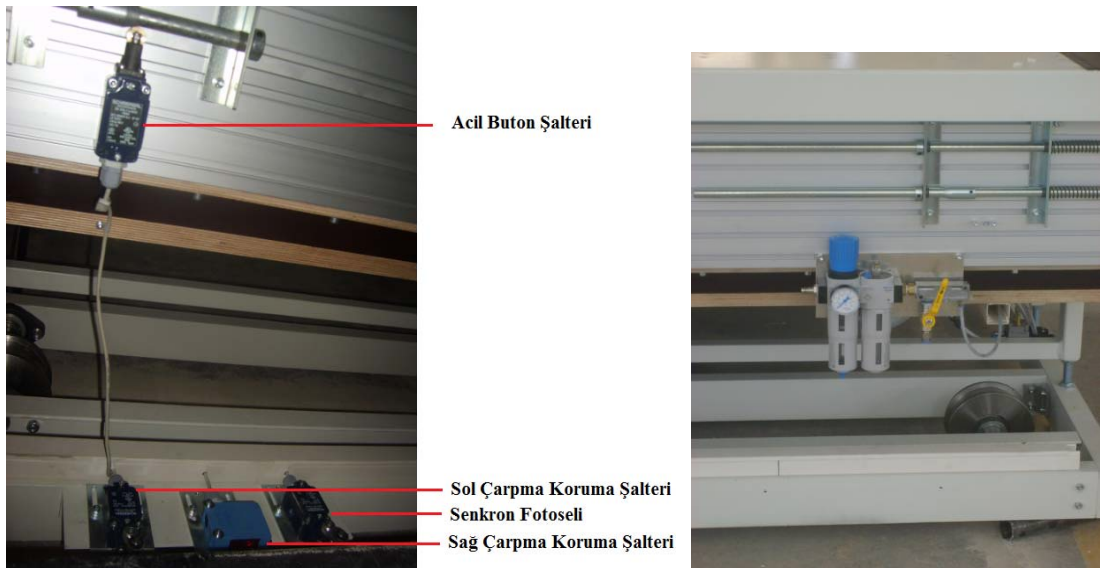
Şekil 3.11 Solda acil buton şalterler sağdaysa Pnömatik tansiyon ve yağlama hava akış aparatı (Çekim ve düzenleme: M.S.Ç.)
