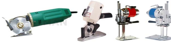
Şekil 1.6 Elle Hareket Ettirilen Kumaş Kesim Makineleri: elektrikli el makası, yuvarlak bıçaklı ve dik bıçaklı kesim makineleri
