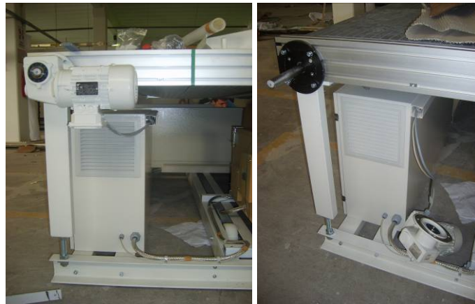
Şekil 3.66 Toplama bandı motorunun sökülmesi (Çekim ve düzenleme: M.S.Ç.)
