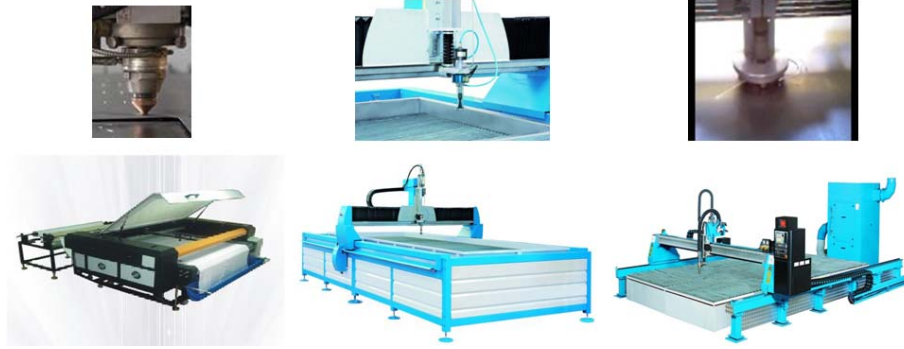
Şekil 1.8 Soldan sağa doğru: lazerli, su jetli ve plazma jetli kesim makineleri
