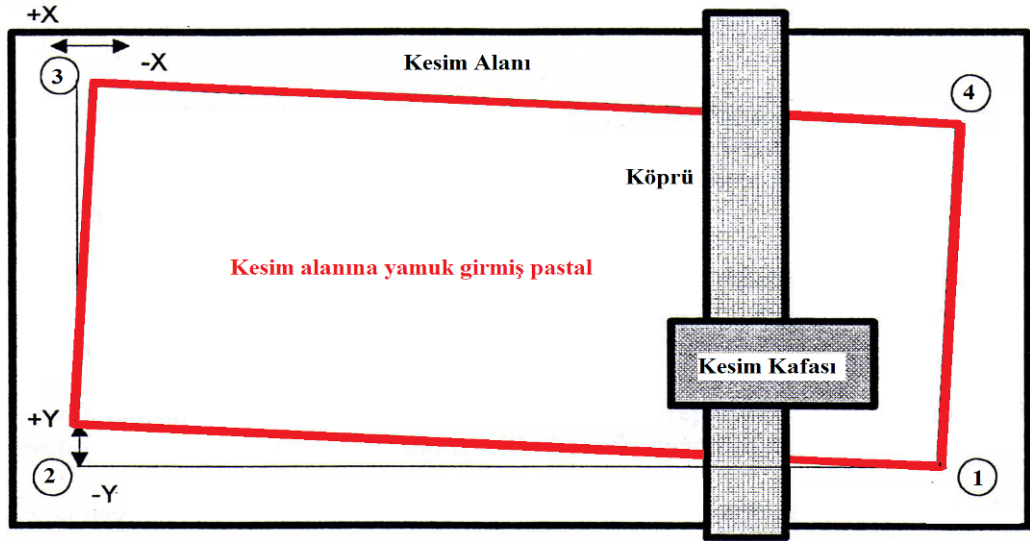
Şekil 3.191 Kesim alanına yamuk girmiş bir pastalın temsili görüntüsü
