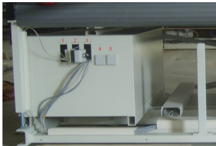
Şekil 3.73 CNC yandan görünüş (1,2,3: kablo geçiş delikleri, 4= x5: monitör fişi için priz, 5= x6= priz) (Çekim ve düzenleme: M.S.Ç.)
