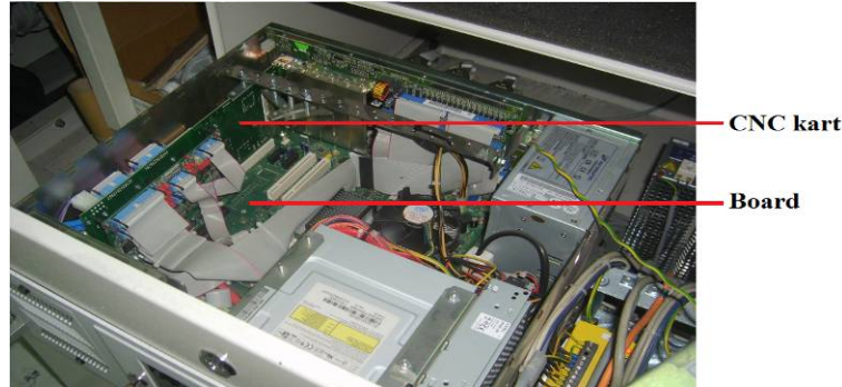
Şekil 3.44 CNC panosunun bileşenlerinden CNC kart ve board görünümü (Çekim ve düzenleme: M.S.Ç.)
