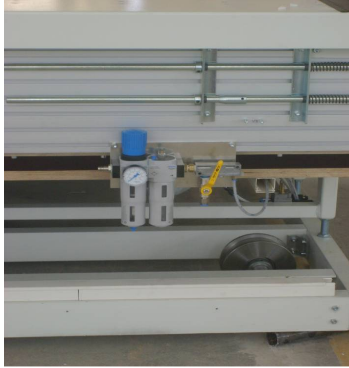
Şekil 3.58 Pnömatik tansiyon ve yağlama hava akış aparatı (Çekim ve düzenleme: M.S.Ç.)
