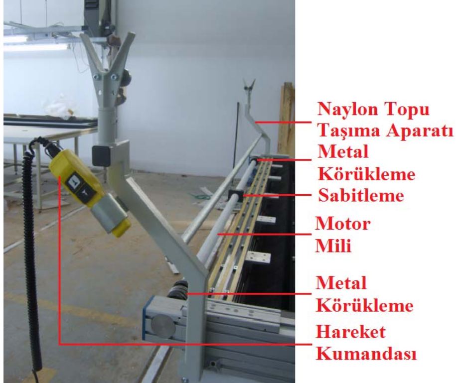
Şekil 3.53 Nylon topu taşıma aparatı, motor mili, hareket kumandası (Çekim ve düzenleme: M.S.Ç.)
