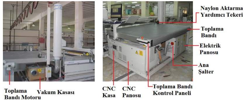
Şekil 3.42 Toplama masası ana bileşenleri (Çekim ve düzenleme: M.S.Ç.)
