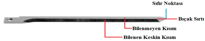
Şekil 3.175 Cutter bıçağının bölümleri
