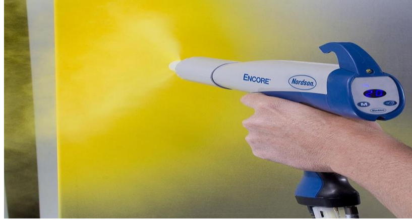
Şekil 2.12 Püskürtme Kaplama Tekniğinin temsilen gösterimi
