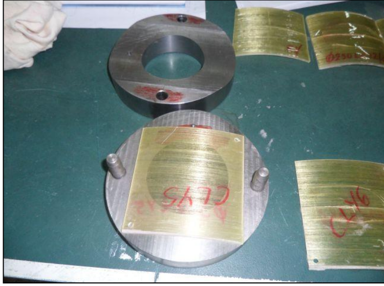
Şekil 5.16 Deney aparatı ve örnek numunenin oturma şekli.
