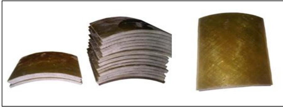
Şekil 5.4 100 ve 125 mm eğrilik yarıçapına sahip numuneler
