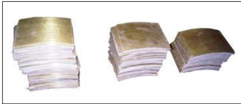
Şekil 5.2 Sırasıyla 320 mm (0°), 250 mm (55°), 200 mm (55°) numuneleri
