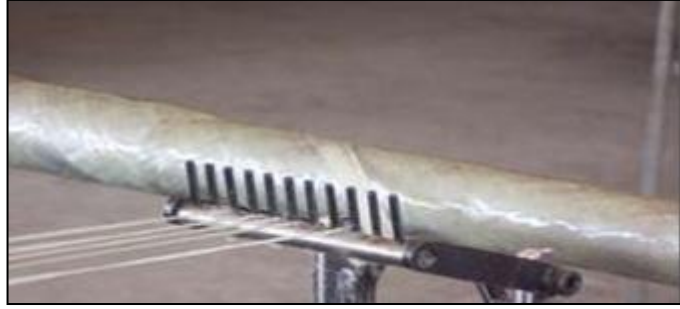
Şekil 5.3 Elyafın sarım yöntemi (İZOREEL)
