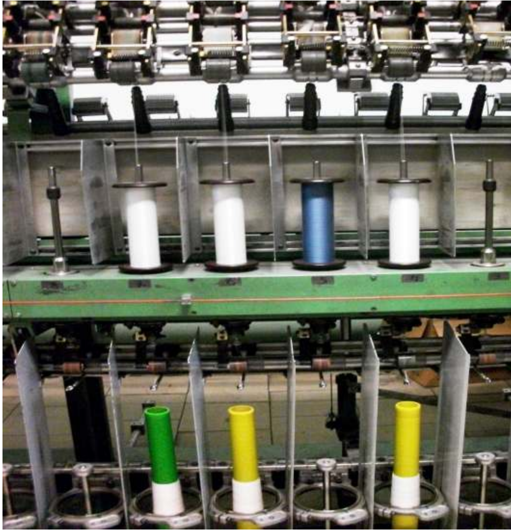
Şekil 3.10 Metal tellerin fantezi iplik makinesi üzerine yerleşimi
