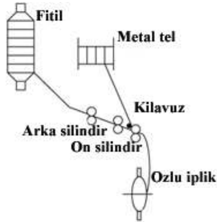
Şekil 2.21 Modifiye edilmiş ring iplik makinasında, fitil ve metal telin özlü iplik eğirme sistemi mekanizmasındaki işlevini gösteren diyagram (Lou, 2005)
