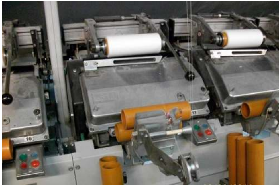
Şekil 3.13 Metal tellerin katlama iplik makinesi üzerindeki yerleşimi
