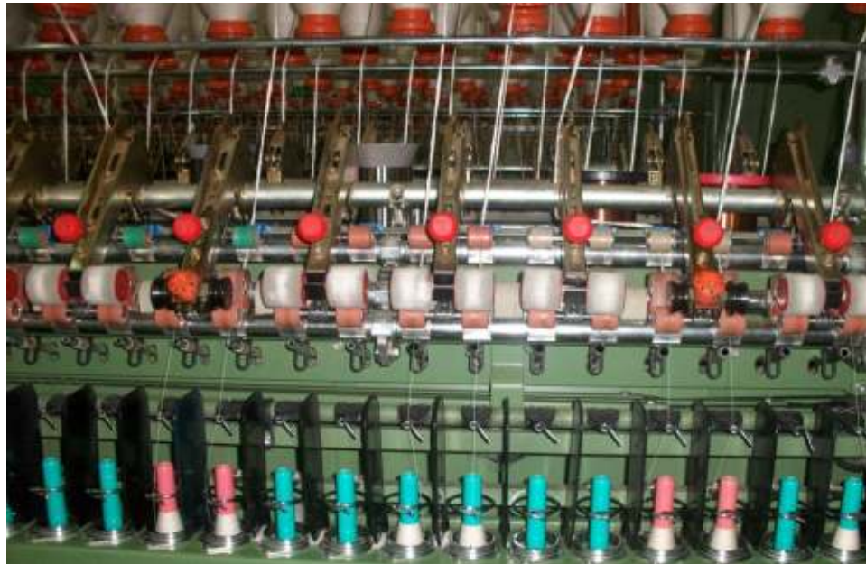
Şekil 3.8 Metal tellerin ring iplik makinesi üzerine yerleşimi
