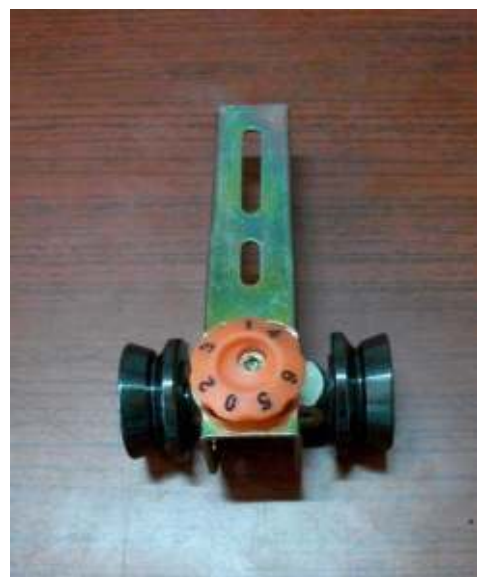
Şekil 3.6 Ring iplik makinesinde kullanılan lycra aparatının görünümüleri
