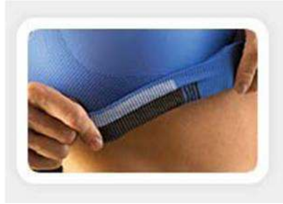
Şekil 2.28 Kalp ritmini ölçebilen tişört ve kalp atış hızını ölçebilen ve monitöre aktarabilen sütyen (Textronics, 2006)
