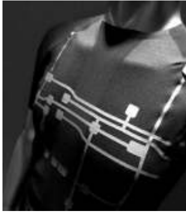
Şekil 2.28 Kalp ritmini ölçebilen tişört ve kalp atış hızını ölçebilen ve monitöre aktarabilen sütyen (Textronics, 2006)
