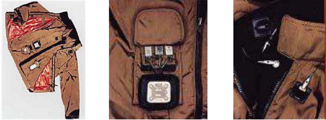
Şekil 2.36 Mooring ceket (a); Ceketin iletişim sistemi (b); Ceketin hoparlör ve mikrofonu (c) (Meoli, 2002; De Vries ve Traldi,2000)
