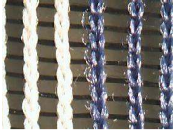
Şekil 2.29 Kumaş yapısı içindeki iletken ipliklerin paralel yerleşimi (Kayacan ve Bulgun, 2008)
