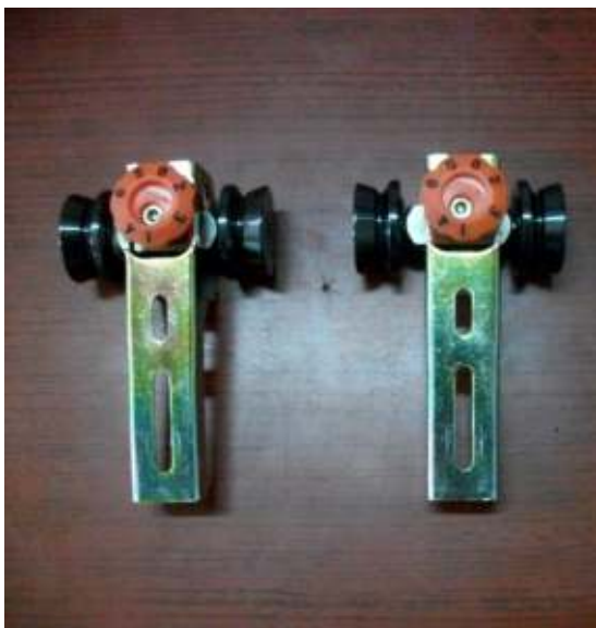
Şekil 3.6 Ring iplik makinesinde kullanılan lycra aparatının görünümüleri
