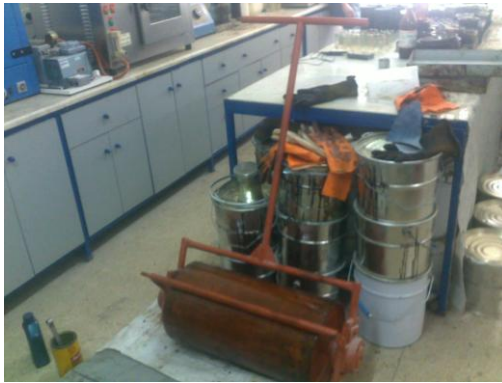
řekil 5.5 Sıkıřtırma iřeminde kullanılan el silindiri
