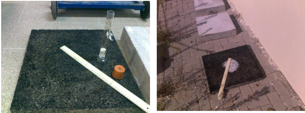
Şekil 5.45 Kum yama deneyinin uygulanıŐ
