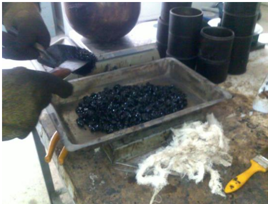
Şekil 5.13 Yoğun gradasyonlu asfalt üretim aşamaları
