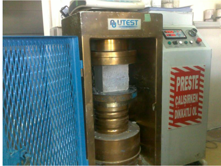
Şekil 5.26 Küp numunelerin basınç dayanımının belirlenmesi
