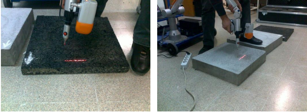
Şekil 5.49 Numunelere lazer taramanın uygulanması
