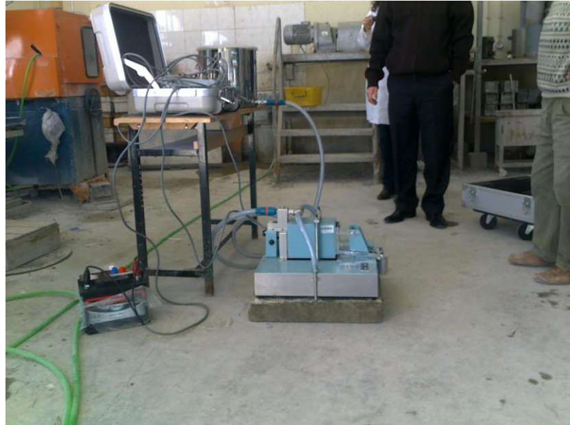
Şekil 5.46 Dinamik sürtünme ölçer deneyinin uygulanması
