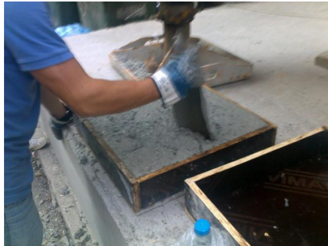
ekil 5.23 Beton numunelerin döküm esnası
