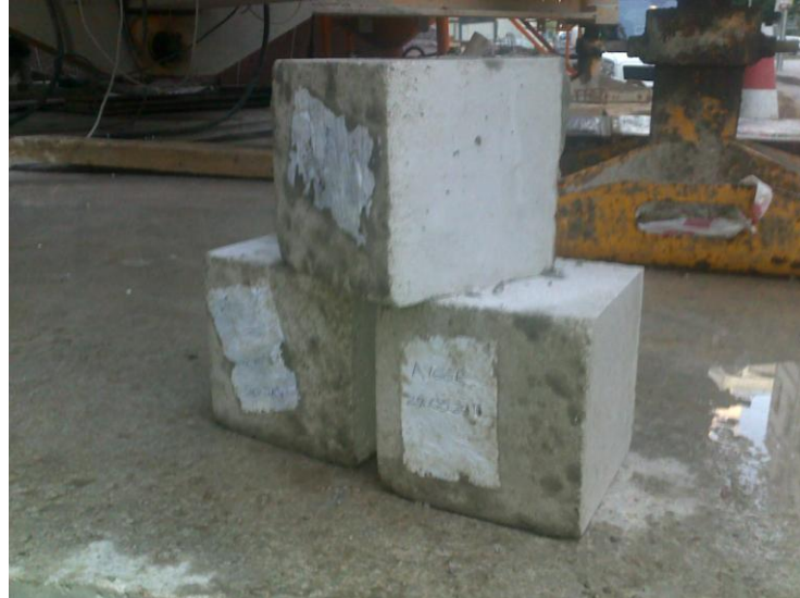
Şekil 5.25 Dayanım ölçümü için hazırlanan küp numuneler
