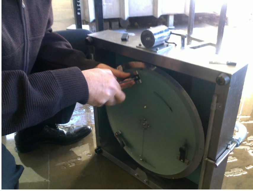
Şekil 5.47 Dinamik sürtünme ölçer test cihazının kauçuk pabuçlarının deęiřtirilmesi
