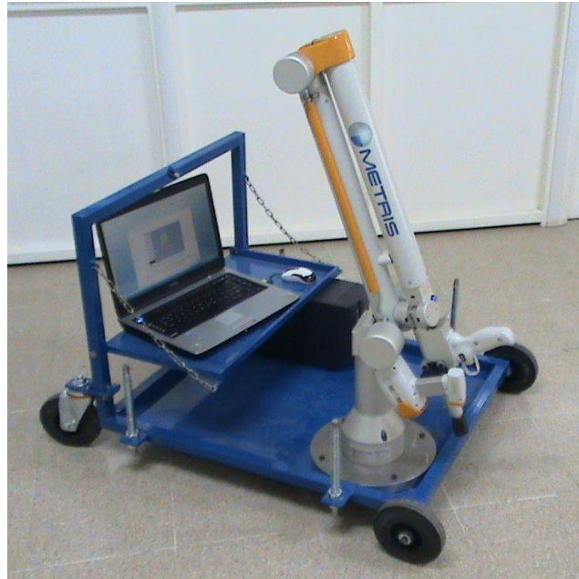
Şekil 5.32 Lazer tarama sistemi ve yazılımı için geliştirilen taşıma aparatı
