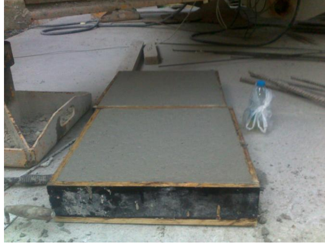
Şekil 5.24 Beton numunelerin döküm sonrası
