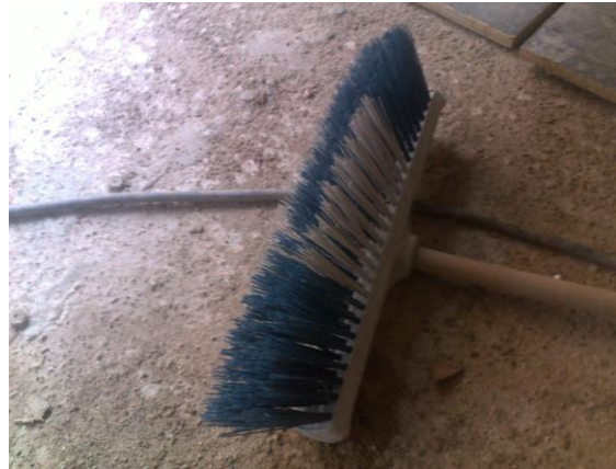
Şekil 5.21 Beton numunelerin pürüzlendirilmesi için fırça
