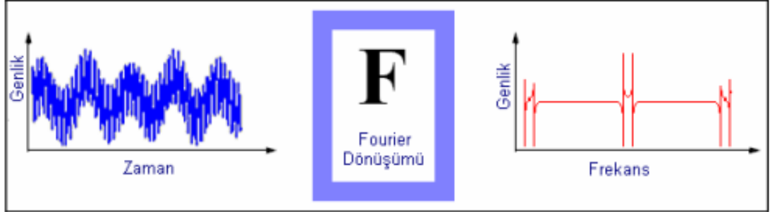
Şekil 4.8 1B Fourier dönüşümü ile veri zaman ortamından frekans ortamına geçer.
