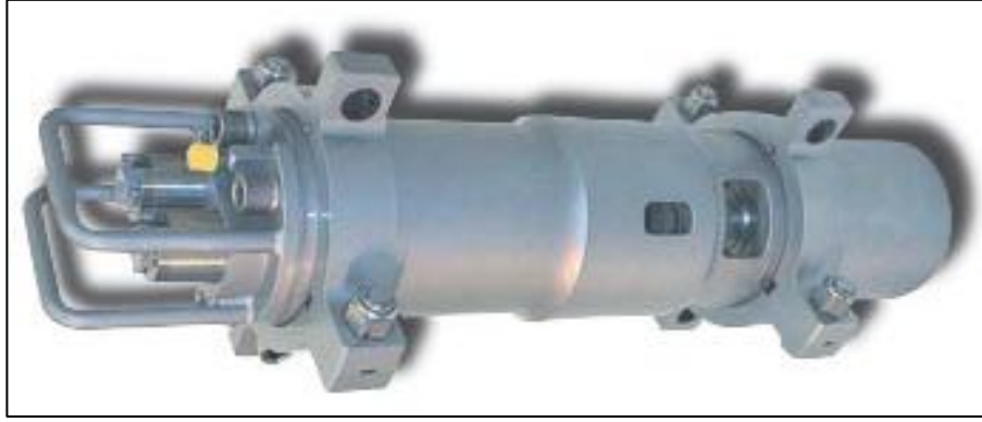
Şekil 3.3 Çalışmada kullanılan GI tipi hava tabancası.
