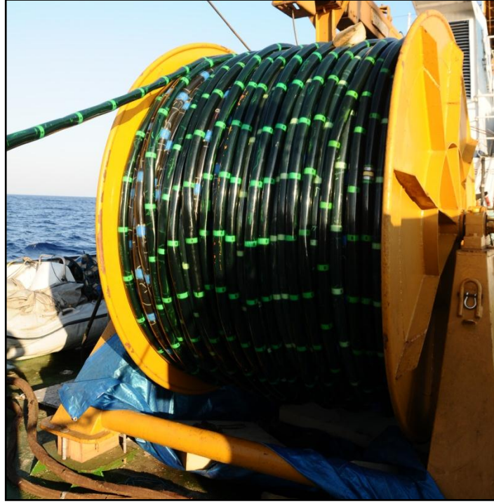
Şekil 3.4 Sismik yansıma çalışmalarında kullanılan dijital sismik alıcı kablosu (sismik streamer).
