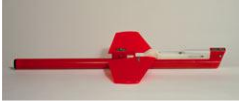
Şekil 3.6 Alıcı kablo üzerine monte edilen derinlik düzenleyicileri (Bird).
