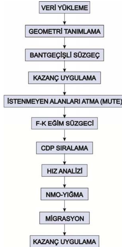
Şekil 3.3. Sismik veri setine uygulanan veri işlem basamakları ve işlem akışı.
