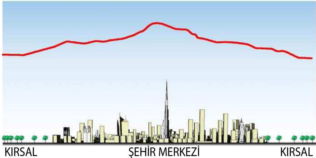
Şekil 2.13 Kentsel Isı Adası Etkisi –Sıcaklık Profili (Green Roof Manual, 2009)
