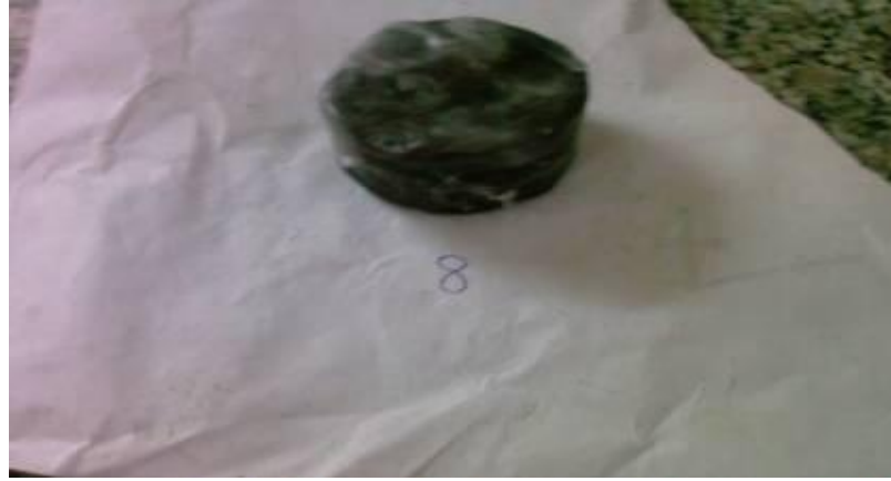
Şekil 3.18 Parafinle kaplanmış karot örneği.
