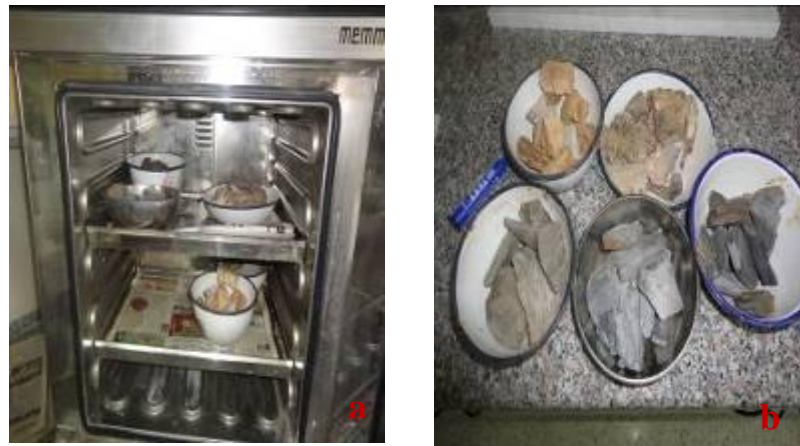
Şekil 3.21 (a) Fırındaki örnekler., (b) Kuruma öncesi şeyl örnekleri
