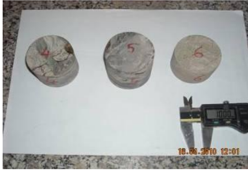
Şekil 3.15 Uçları kesilen şeyl karot örnekleri.
