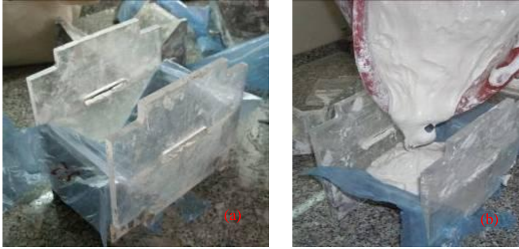
Şekil 3.10 (a) Deney için hazırlanan örnek kalıbı, (b) Kalıbın içine dökülen bağlayıcı malzeme.
