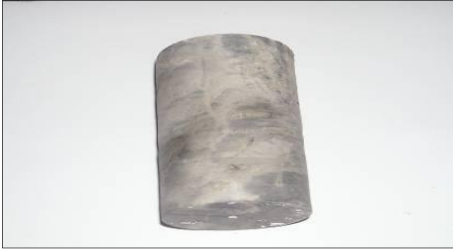
Şekil 3.8 Üst ve alt yüzeyleri deney için uygun hale getirilmiş karot örneği.
