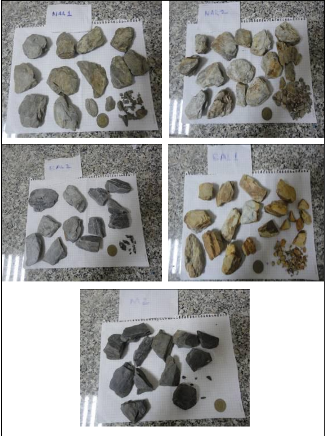
Şekil 3.23 Şeyllerde 1. çevrim sonucu gözlenen fiziksel değişimler.
