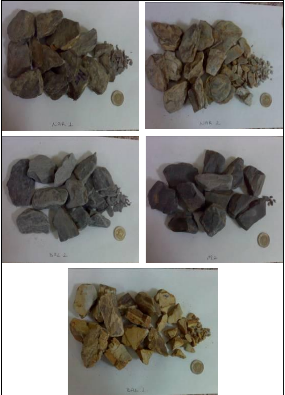
Şekil 3.24 Şeylerde 2. çevrim sonucu gözlenen fiziksel değişimler.
