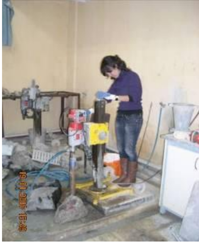
Şekil 3.5 Laboratuvarında karot alımı.
