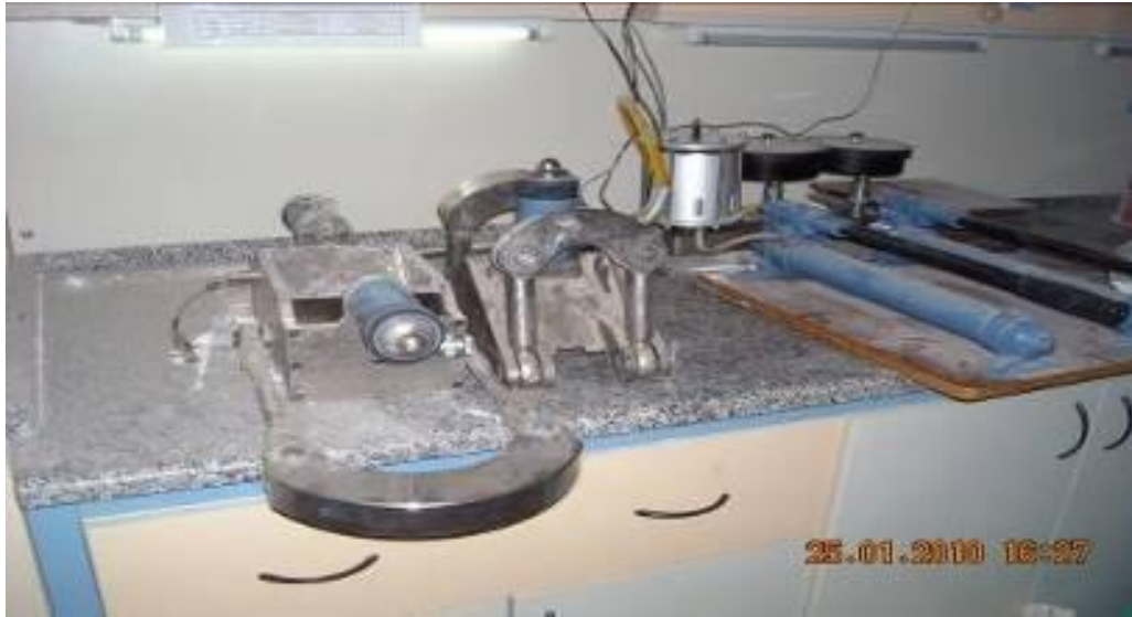
Şekil 3.3 Labaratuvarıda kullanılan portatif kesme kutusu deney düzeneği.
