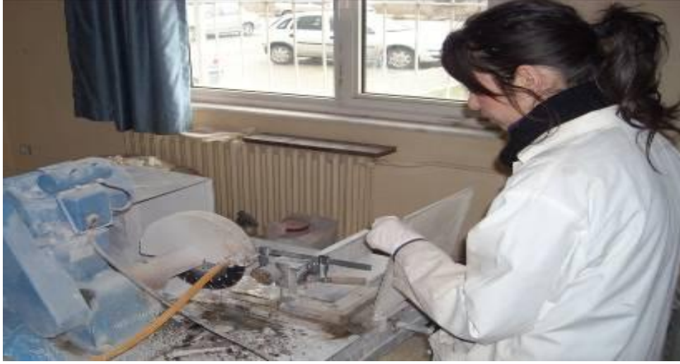
Şekil 3.7 Alınan karot örneklerinin deney kalıplarına uygun hale getirilmesi.
