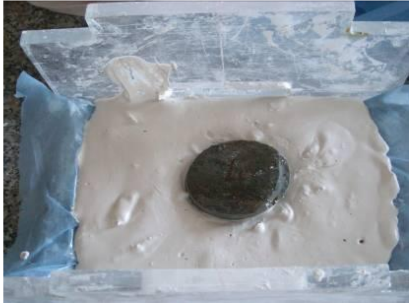
Şekil 3.11 Kesme kutusu deneyi için numunenin kalıp içindeki konumu.
