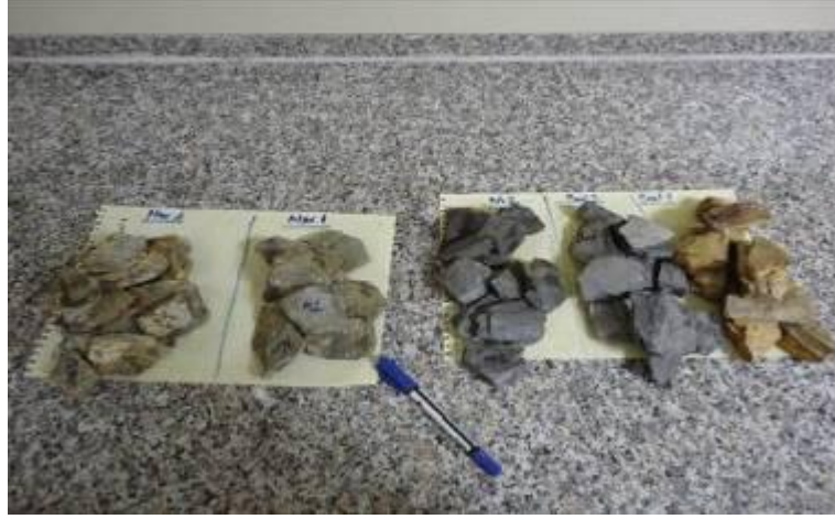
Şekil 3.20 Deney için hazırlanan 40-60 g ağırlıklı şeyl örnekleri.
