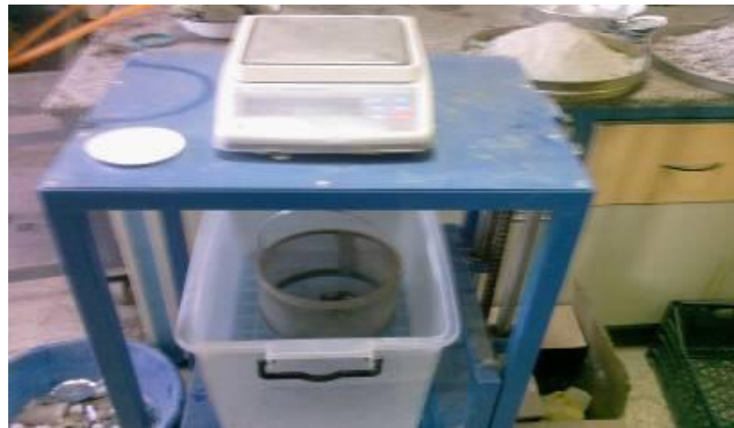
Şekil 3.19 Parafinli numunenin ağırlık ölçümü.
