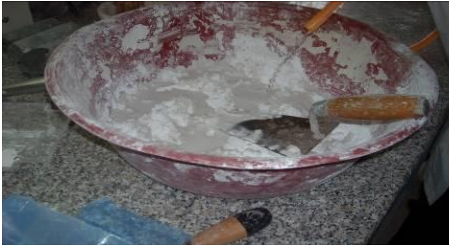
Şekil 3.9 Kesme kutusu deneyi için örnek hazırlamada kullanılan alçının su ile kıvamlı hale getirilmesi.
