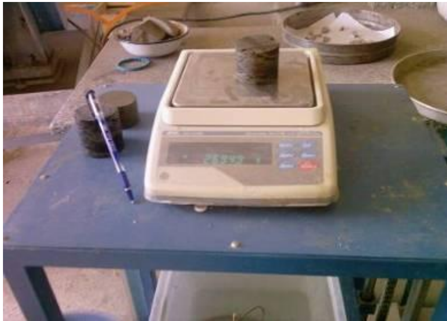
Şekil 3.17 Suya doymun numunelerin Arşimet terazisi'nde ağırlık tayini.
