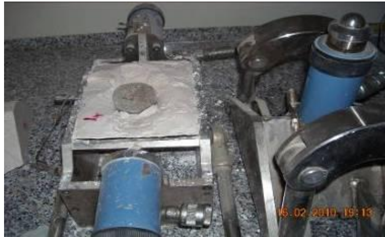
Şekil 3.13 Kalıpların makaslama kutusuna konulması.
