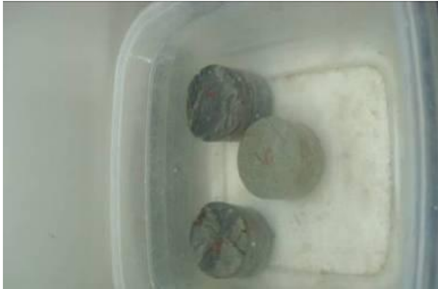
Şekil 3.16 Karotların suya doymun hale getirilmesi.
