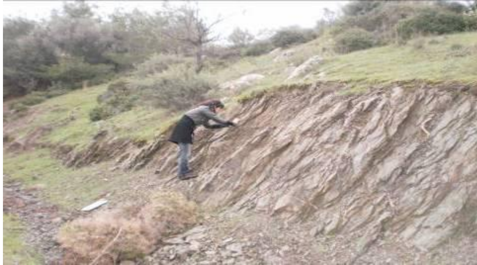
Şekil 1.3 Şeyl ağırlıklı kumtaşı-şel aralanmasında yüzeysel koşullarda (ıslanma-kuruma nedeniyle) şev tabnında meydana gelen kıymık şeklinde parçalanmalar (splitting) Koordinat: X: 490367, Y: 4232018, TK: 310/53, Şev: 271/6
