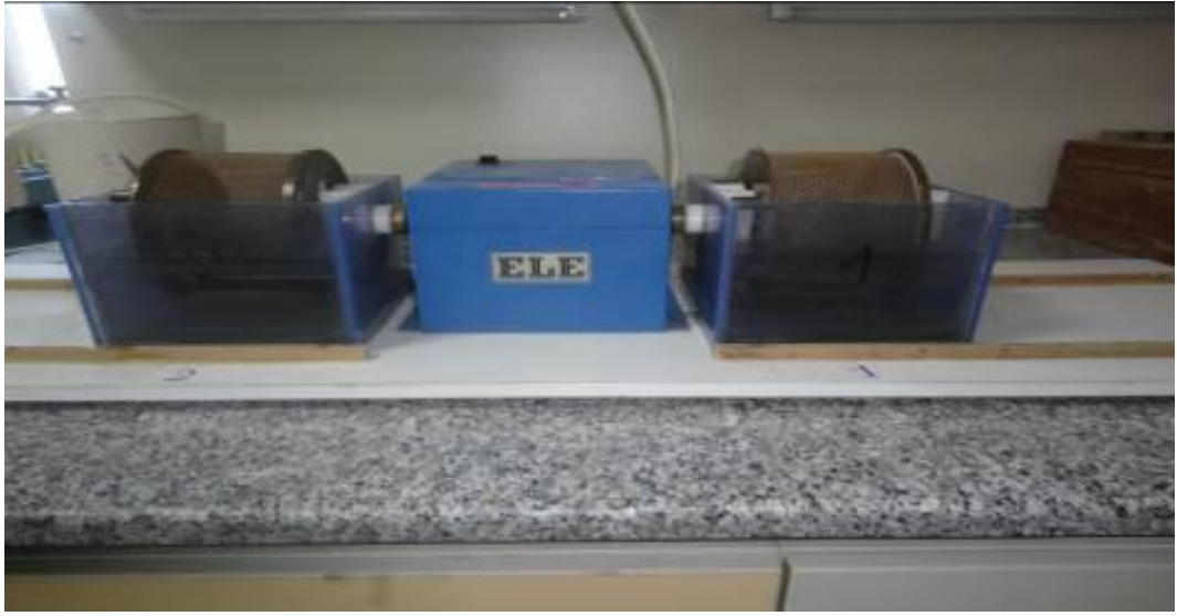
Şekil 3.22 Numune ile birlikte şeffaf hazneye yerleştirilmiş tamburlar (Suda dağılmaya karşı kayacın direncini ölçen alet).
