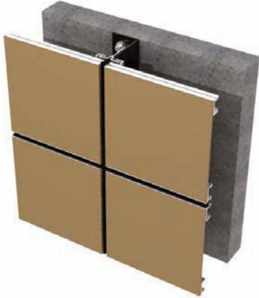
Şekil 3.5 İnce porselen seramik levha Çuhadarođlu SX sistem montaj detayı (www.kale.com.tr, 2012)
