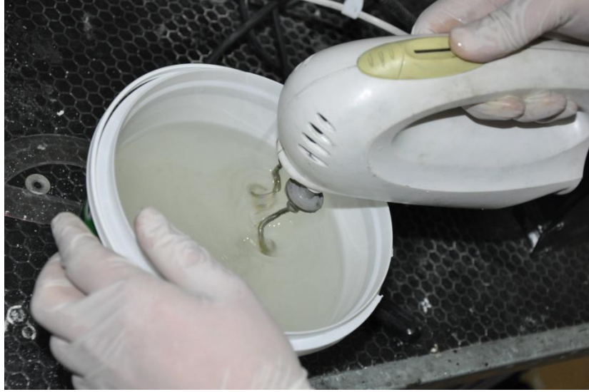
Şekil 4.13 Belli oranlardaki reçine ve sertleştiricinin karıştırılması.
