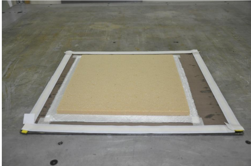
Şekil 4.5 Teflon yüzeyin üzerine elyaf ve köpüklerin yerleştirilmesi.
