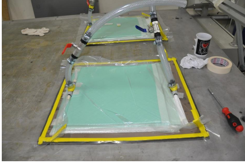
Şekil 4.12 Vakum altına alınmış reçine verilmeye hazır tabaka.
