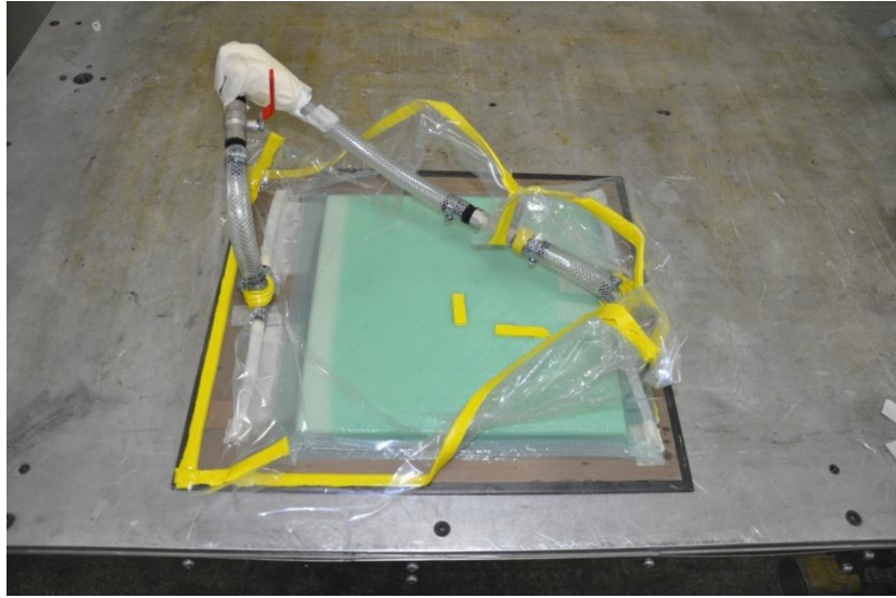
řekil 4.16 K rleřme iřlemi tamamlanmıř ve fırın iinde soėutulmuř tabaka  zerindeki vakum torbası, reine daėıtıcı, soyma kumařı, spiral borulardan temizlenir.
