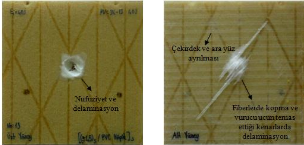
Şekil 5.6 [(\pm 45)_3/\text{PVC Köpük}]_s oryantasyonlu sandviç kompozit numunenin 40 J'de yapılmış darbe deneyi sonrası üst ve arka yüzeylerinden fotoğrafları
