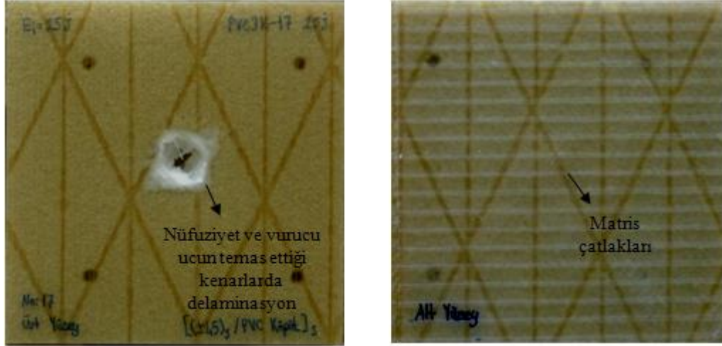
Şekil 5.5 [(\pm 45)_3/\text{PVC Köpük}]_s oryantasyonlu sandviç kompozit numunenin 25 J'de yapılmış darbe deneyi sonrası üst ve arka yüzeylerinden fotoğrafları
