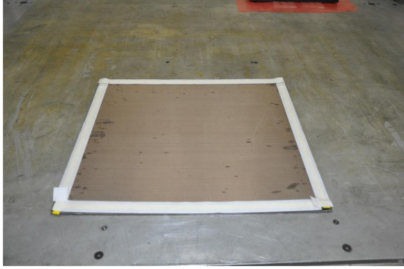
Şekil 4.4 Yaklaşık olarak yarısı teflona yarısı metal levhaya çerçeve oluşacak şekilde yapıştırılmış sızdırmazlık macunu.
