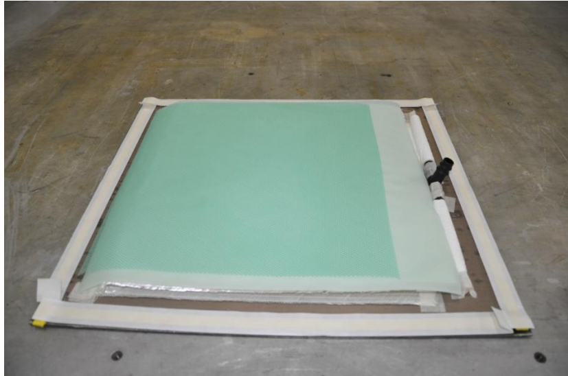
Şekil 4.7 Soyma kumaşı üzerine yerleştirilmiş reçine dağıtıcı.
