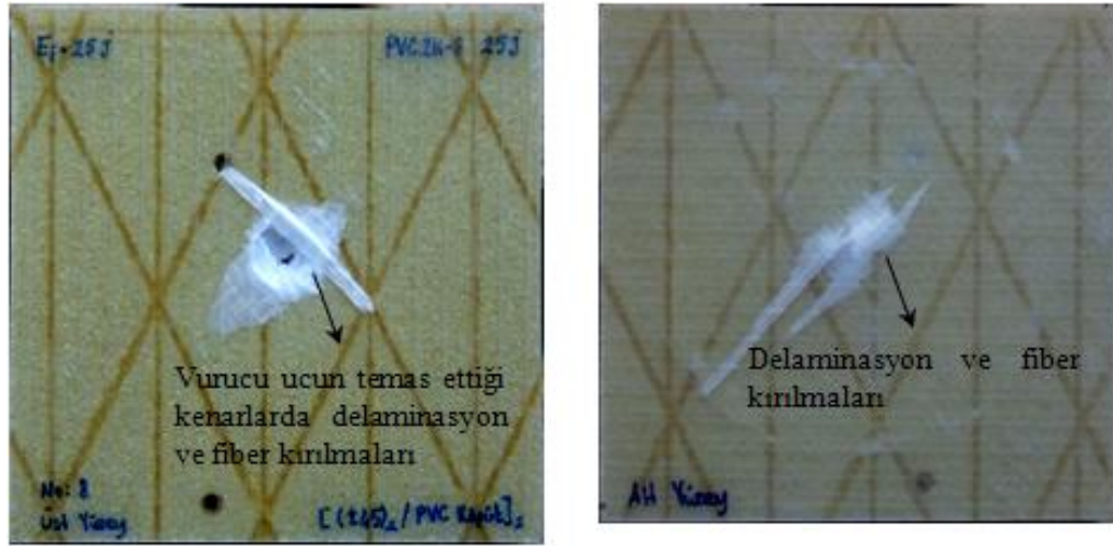
Şekil 5.25 [(\pm 45)_2/\text{PVC Köpük}]_s oryantasyonlu sandviç kompozit numunenin 25 J'de yapılmış darbe deneyi sonrası üst ve arka yüzeylerinden fotoğrafları
