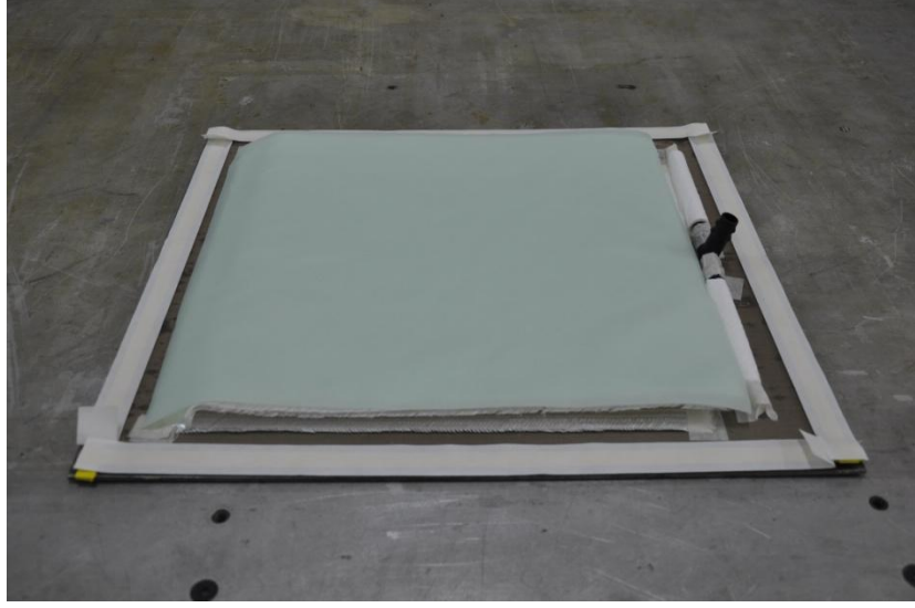
Şekil 4.6 İstiflenmiş elyaf ve köpüklerin üzerini tamamen örtecek şekilde serilmiş soyma kumaşı.
