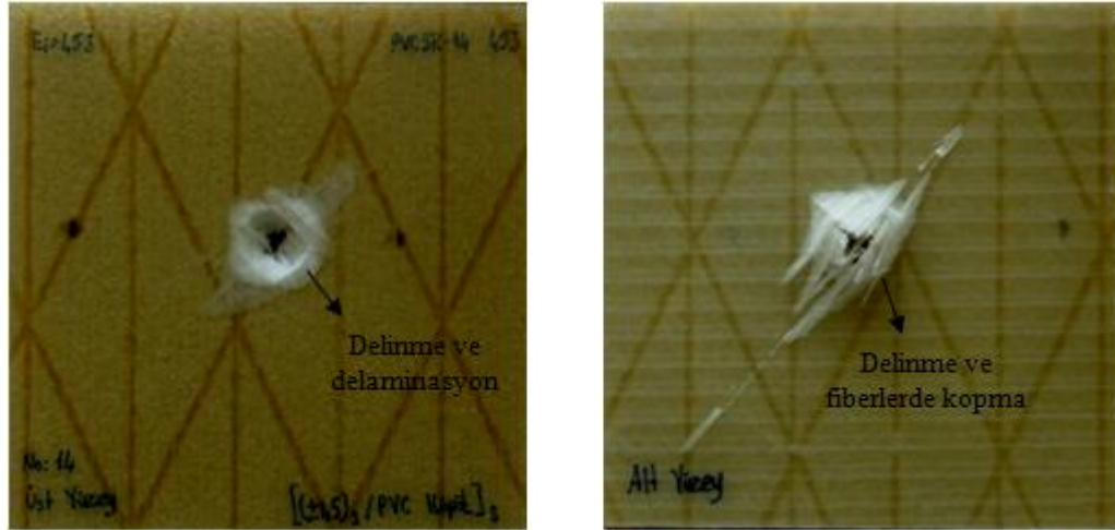
Şekil 5.7 [(\pm 45)_3/\text{PVC Köpük}]_s oryantasyonlu sandviç kompozit numunenin 45 J'de yapılmış darbe deneyi sonrası üst ve arka yüzeylerinden fotoğrafları
