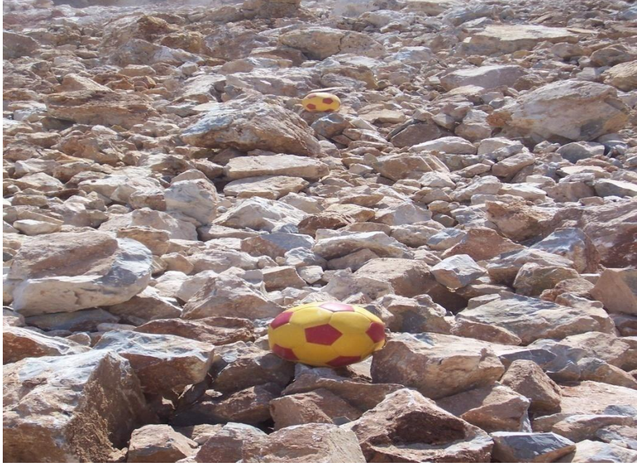
Şekil 4.8 Ölçek kullanılarak elde edilen fotoğraf
