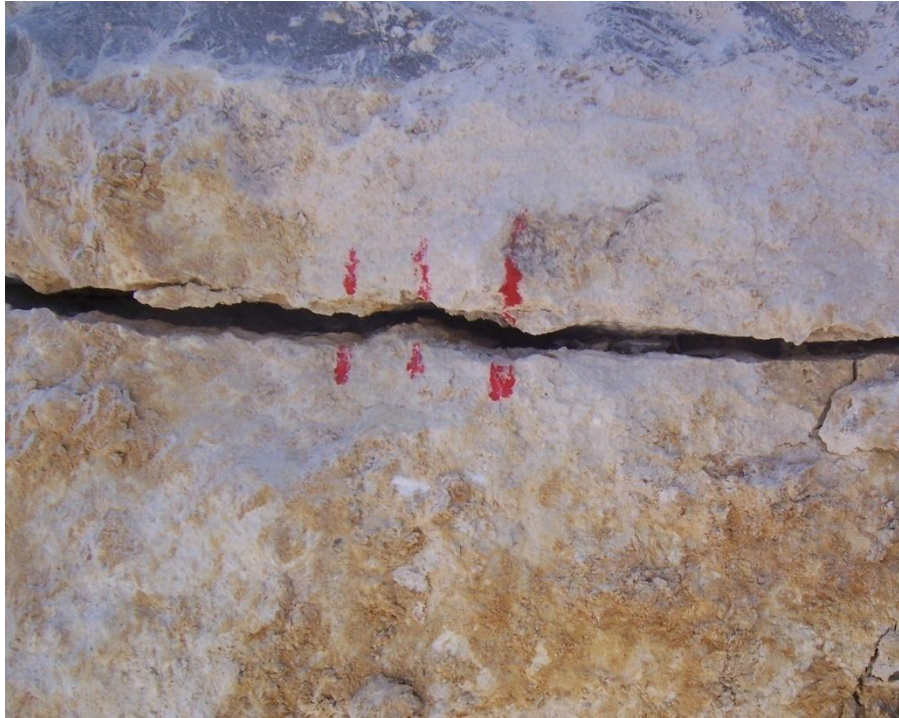
Şekil 5.40 Süreksizlik üzerinde yapılan işaretlemeler
