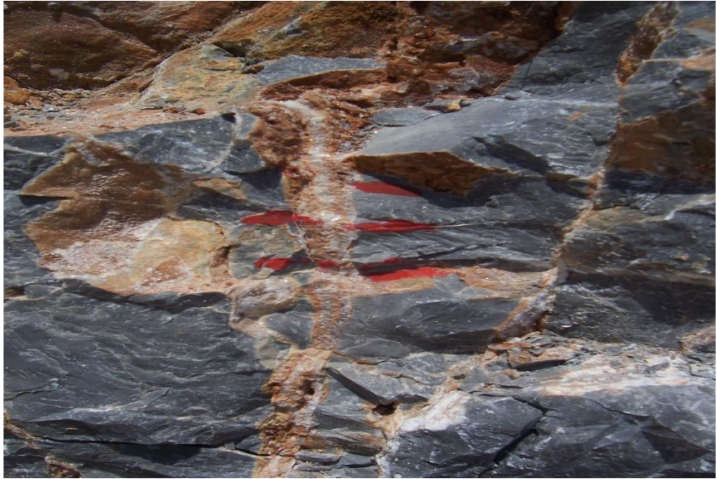
Şekil 3.12 Dolgulu süreksizliğin görüntüsü
