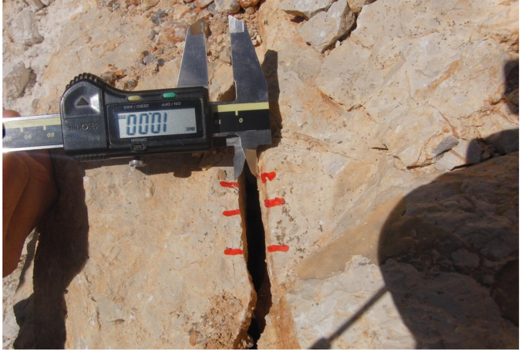
Şekil 5.19 Süreksizlik üzerinde yapılan işaretlemeler ve milimetrik kumpas
