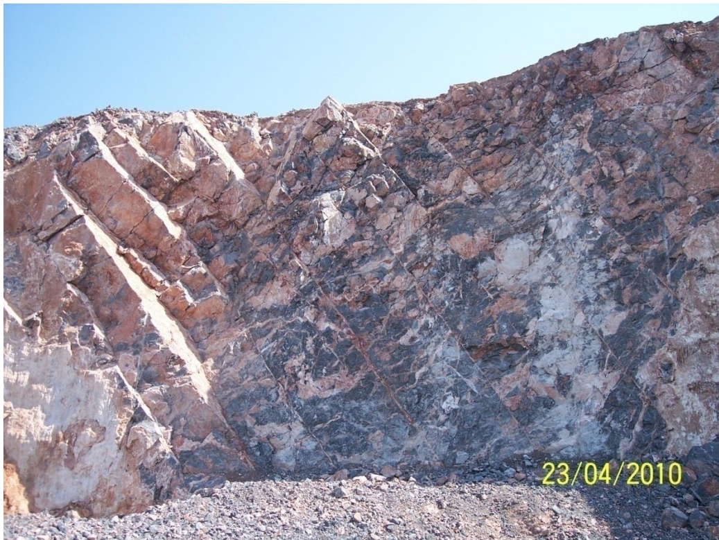
Şekil 3.15 Kaya kütleindeki süreksizlik takımlarının görünümü
