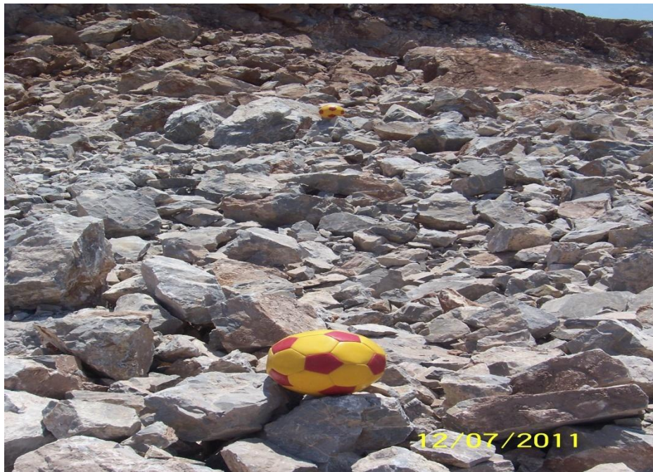
Şekil 5.48 3.aynaya ait patlatma sonrası görüntü
