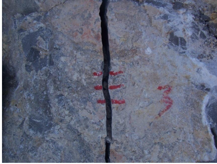
Şekil 5.78 Süreksizlik üzerinde yapılan işaretlemeler
