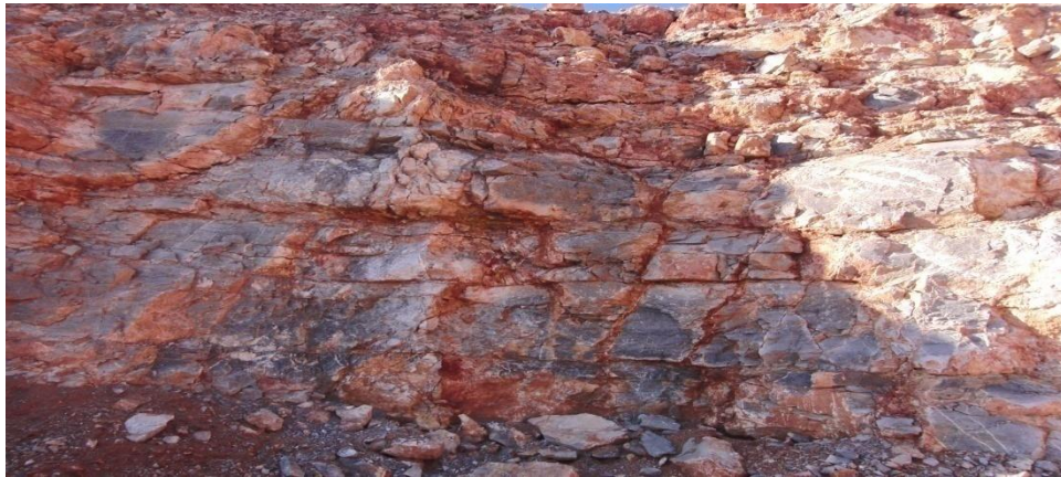
Şekil 2.2 Kaya külesi üzerindeki süreksizliklerin görünümü
