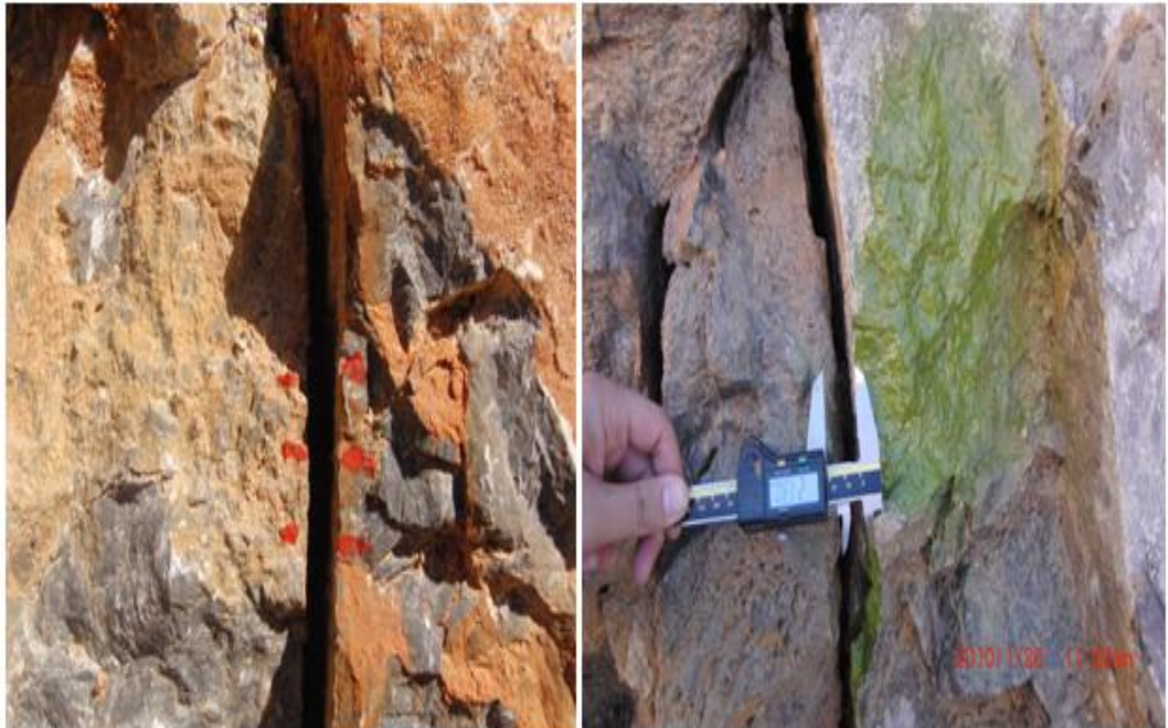
Şekil 5.4 Süreksizlik üzerinde yapılan işaretlemeler ve milimetrik kumpas
