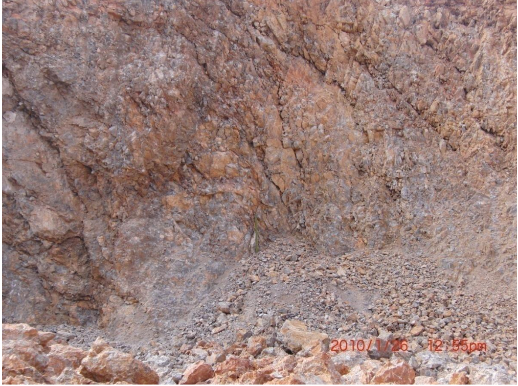
Şekil 3.2 Kaya kütlesi içindeki süreksizliklerin görüntüsü
