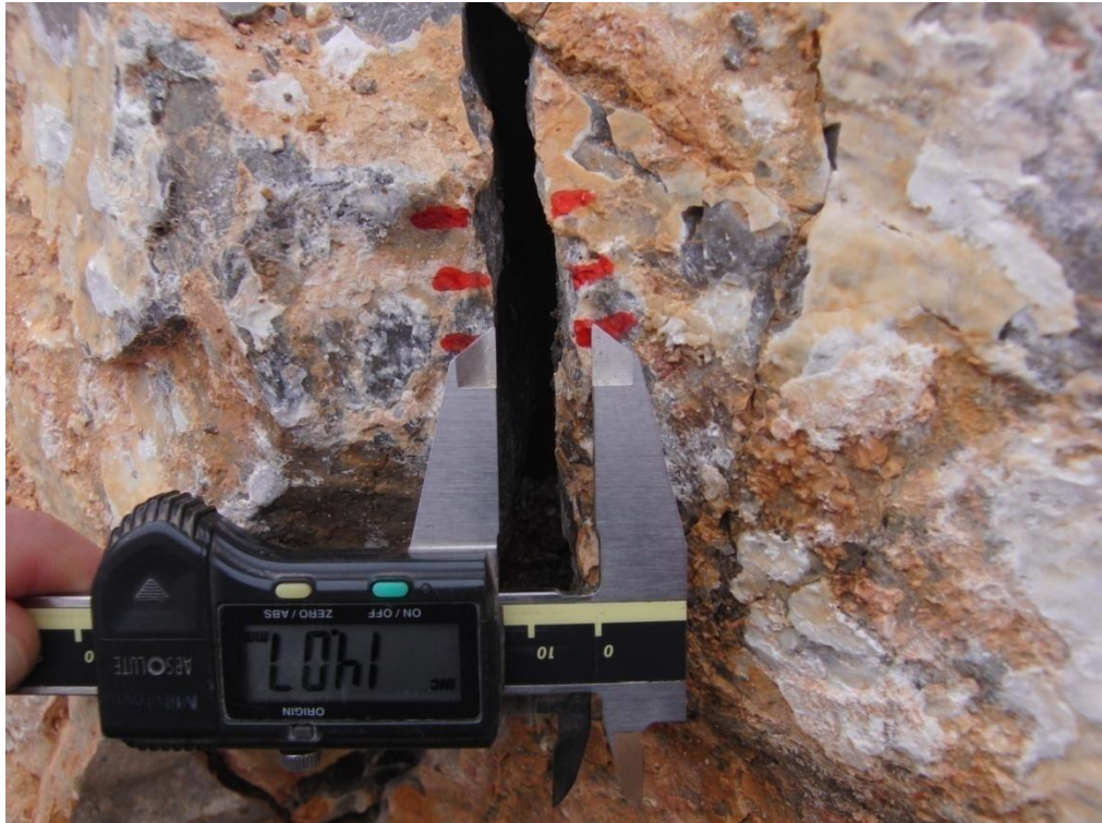
Şekil 5.9 Süreksizlik üzerinde yapılan işaretlemeler ve milimetrik kumpas
