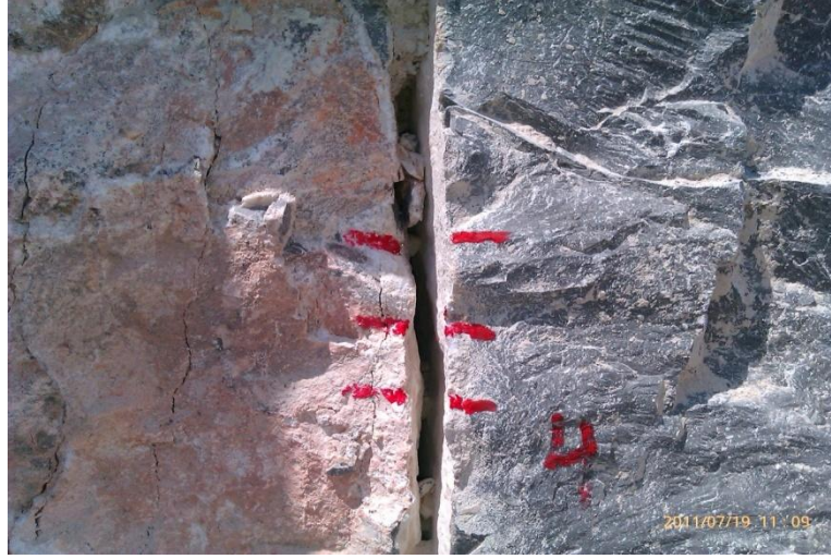
Şekil 5.69 Süreksizlik üzerinde yapılan işaretlemeler
