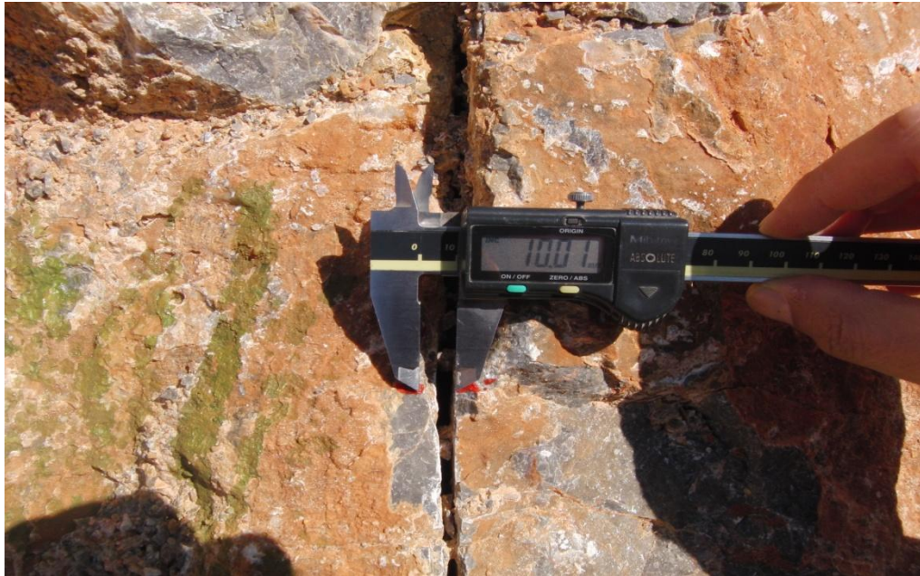
Şekil 5.14 Süreksizlik üzerinde yapılan işaretlemeler ve milimetrik kumpas
