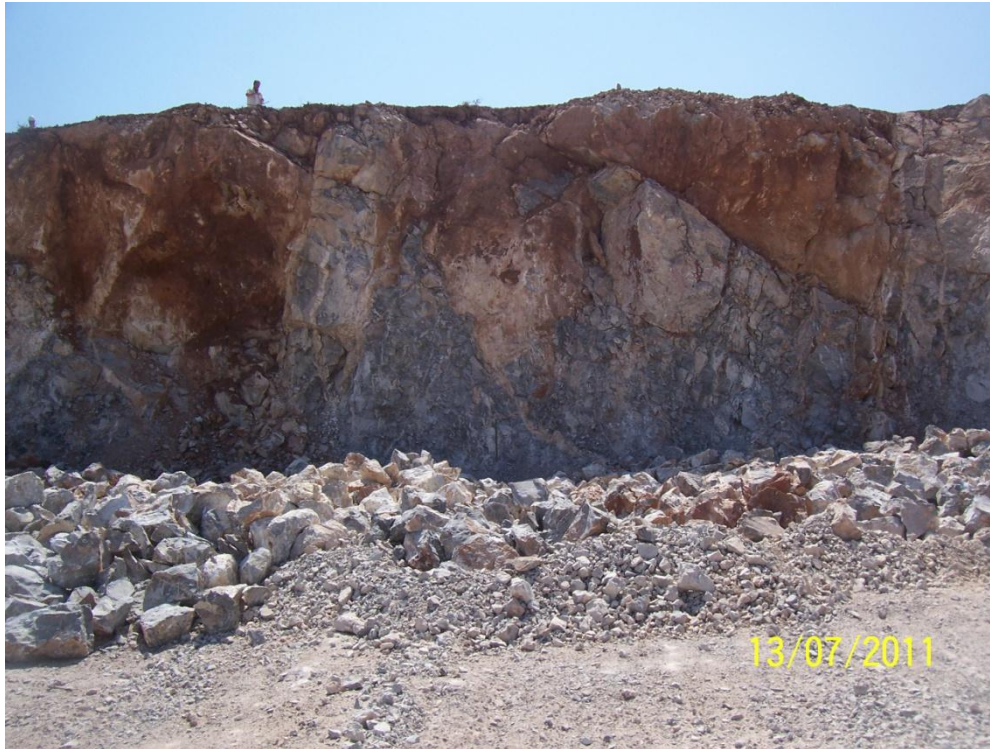
Şekil 2.6 Ayna üzerindeki farklı yönlerdeki süreksizliklerin görünümü
