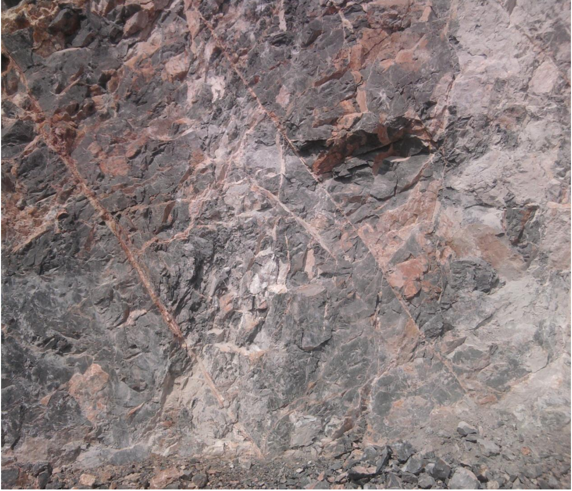
Şekil 3.8 Kaya kütlesi üzerinde gözlenen süreksizliklerin devamlılığı.
