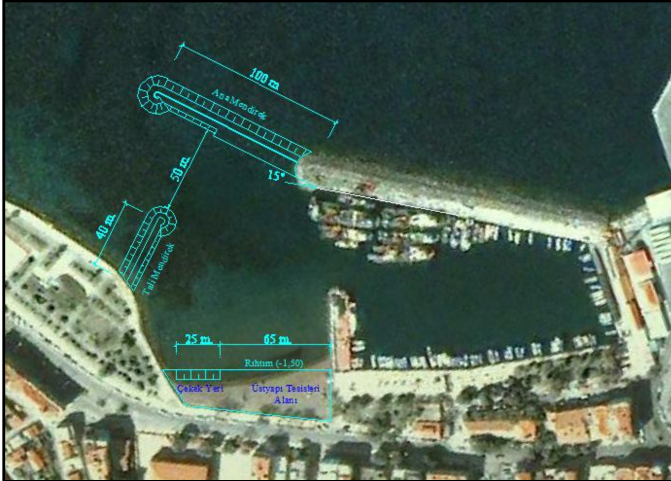
Şekil 5.14 Dikili balıkçı barınağı rehabilitasyon planı.
