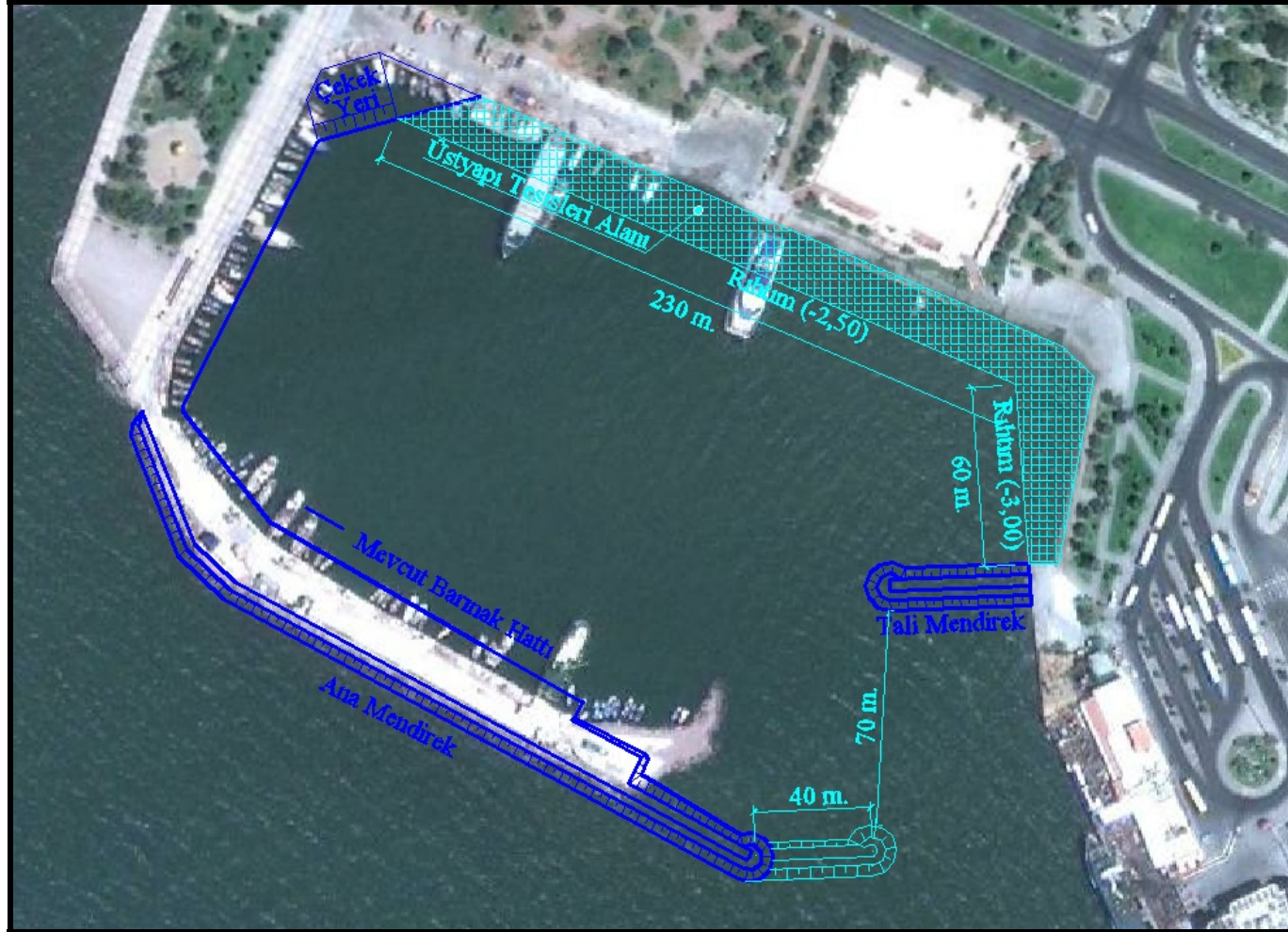
Şekil 5.43 Karşıyaka-Bostanlı balıkçı barınağı rehabilitasyon planı.
