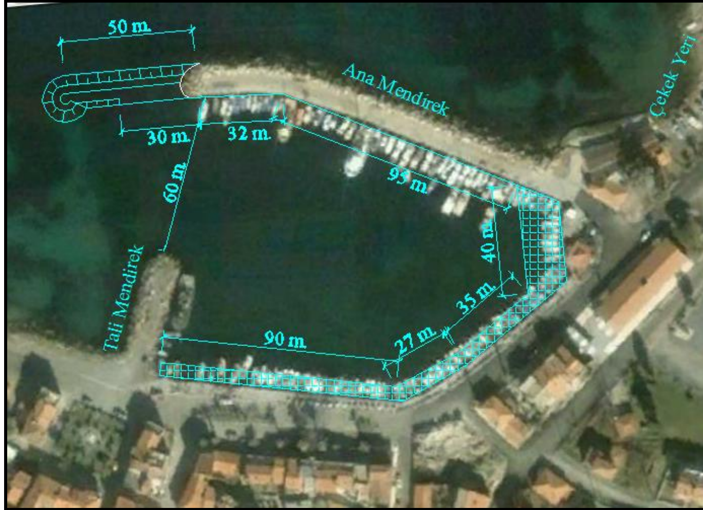
Şekil 5.31 Yeni Foça balıkçı barınağı rehabilitasyon planı.
