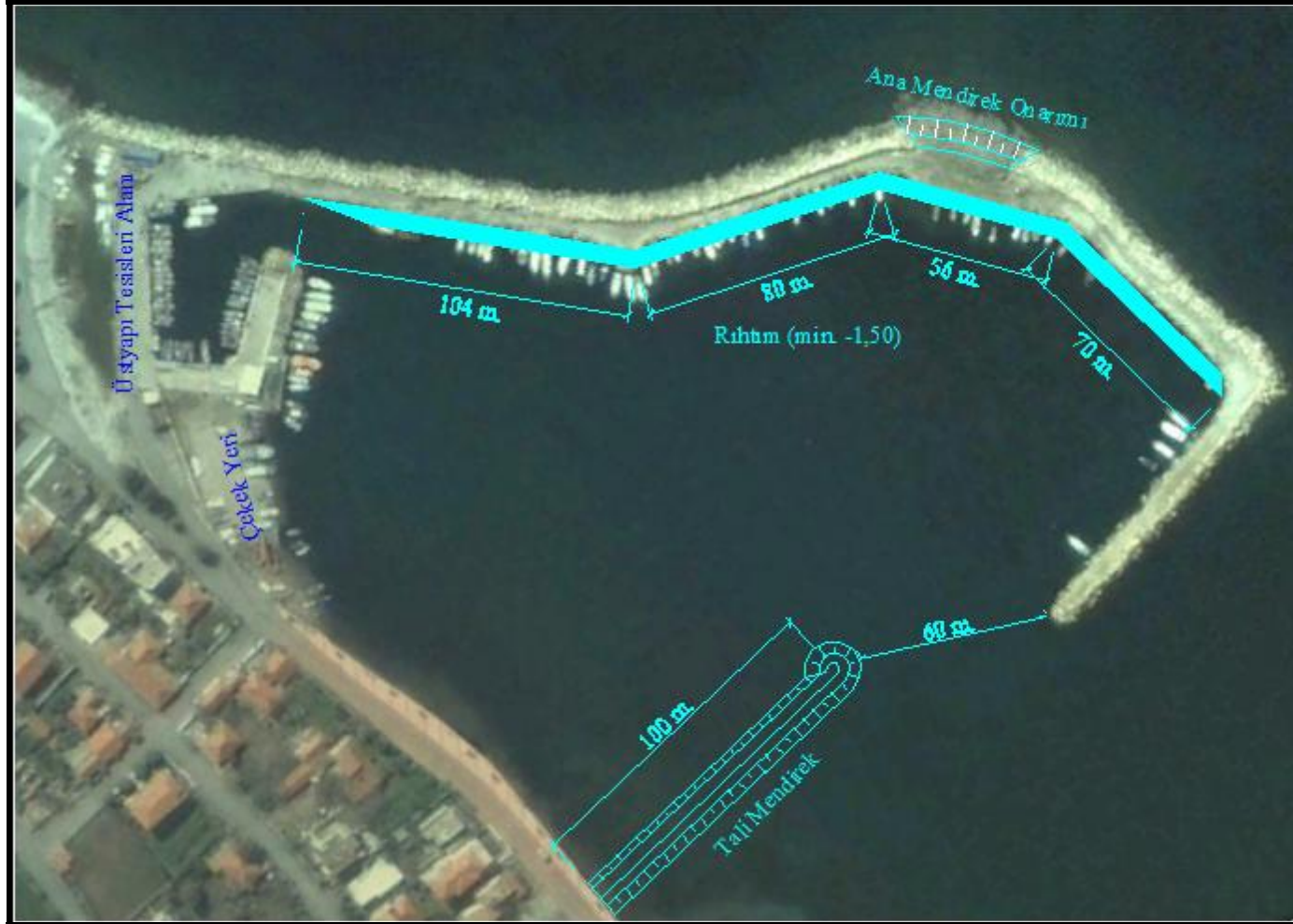
Şekil 5.22 Çandarlı balıkçı barınağı rehabilitasyon planı.
